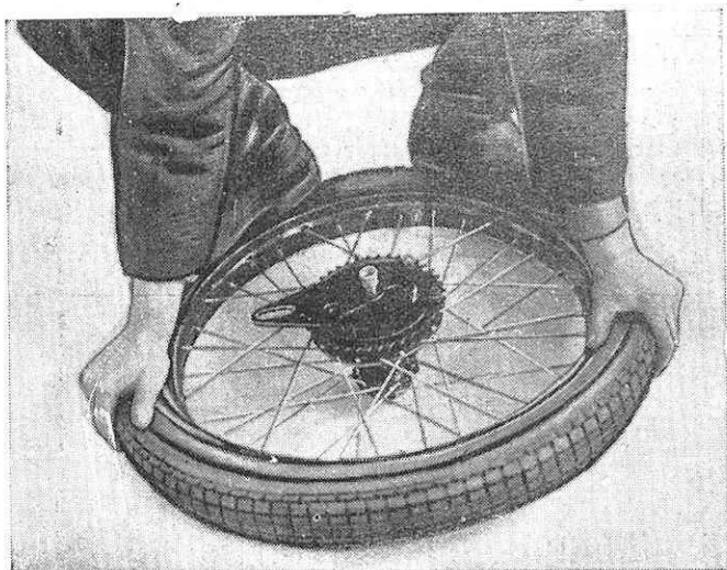
Рис. 32а. Одевание покрышки на колесо.
