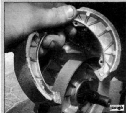
Рис. 61. Замена задних тормозных колодок
