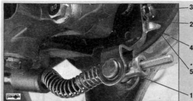
Рис. 57. Регулировочная гайка заднего тормоза и метки износа тормозных колодок заднего тормоза: 1 – регулировочная гайка; 2 – тормозной рычаг; 3 – гайка тормозного рычага заднего тормоза; 4 – метка на тормозном барабане; 5 – метка на тормозном рычаге
