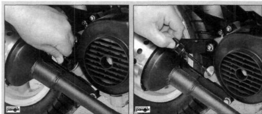
Рис. 15. Проверка уровня моторного масла
