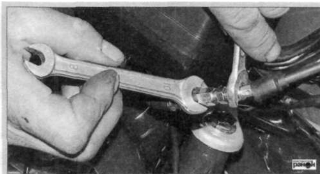
Рис. 37. Регулировка троса акселератора («газа»)
