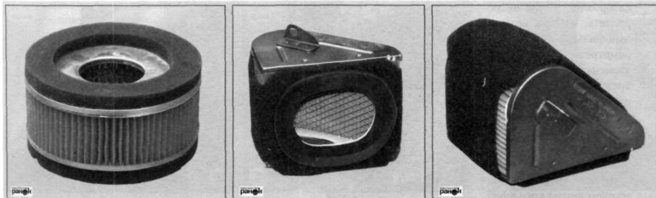
Рис. 11. Фильтрующие элементы воздушных фильтров некоторых моделей скутеров
