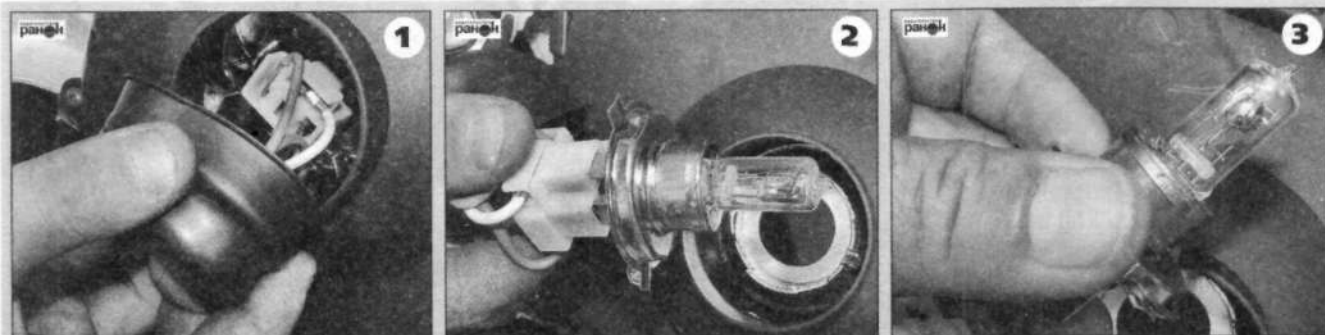
Рис. 80. Замена лампы головного освещения (дальнего/ближнего света)
