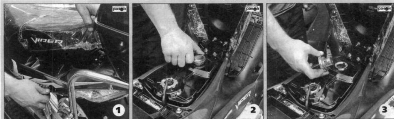
Рис. 7. Заправка скутера топливом
