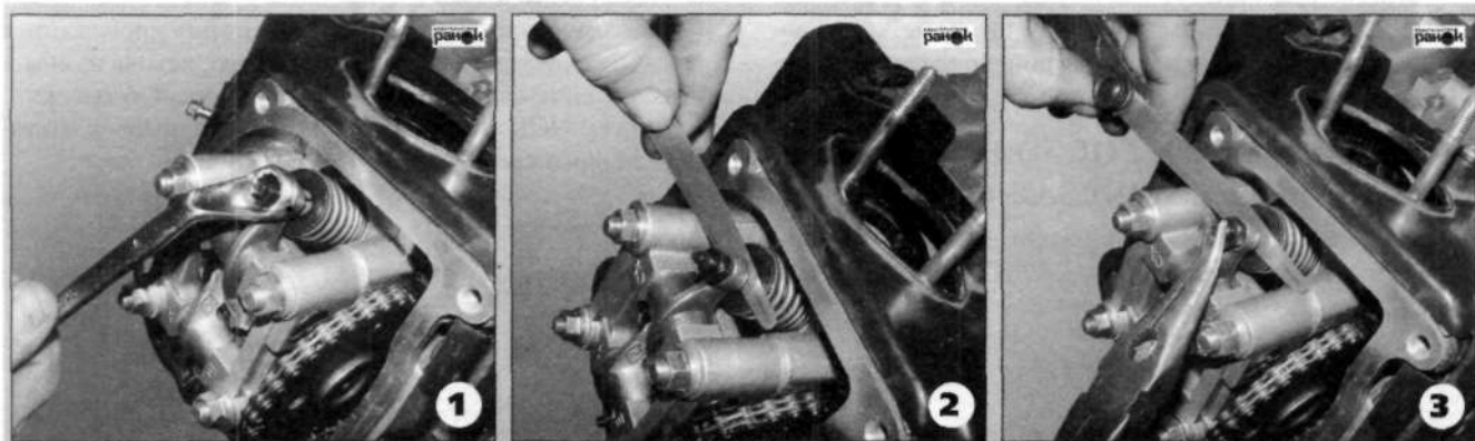
Рис. 25. Проверка и регулировка зазоров клапанов
