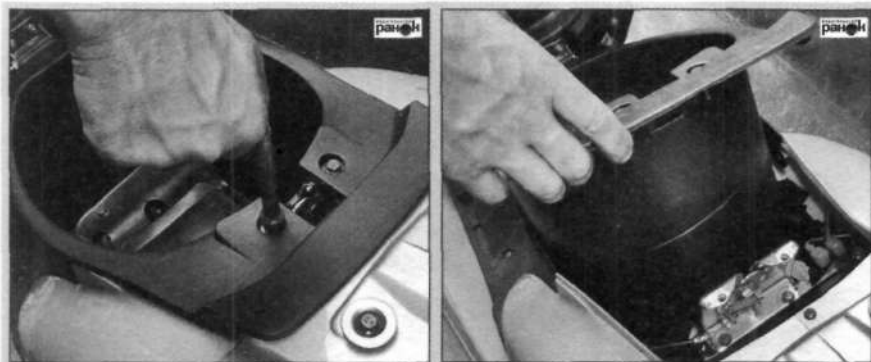
Рис. 32. Снятие корпуса подседельного багажника
