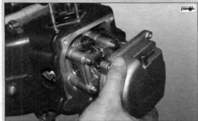
Рис. 23. Снятие клапанной крышки
