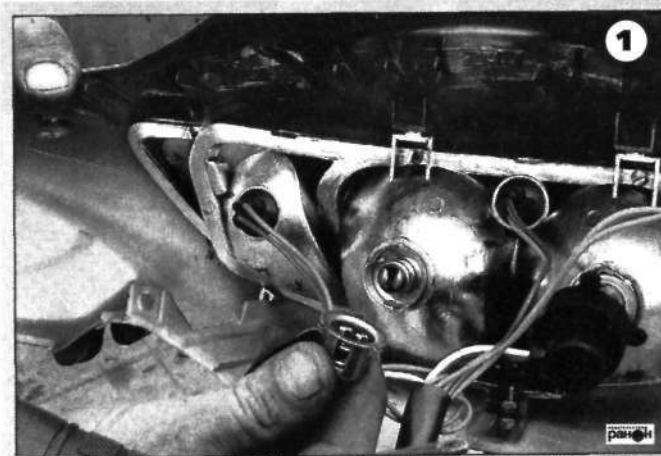
Рис. 64. Замена лампы головного освещения (дальнего/ближнего света)
