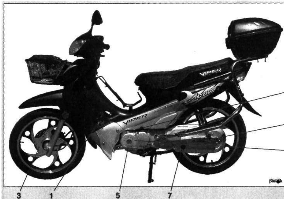
Рис. 16. Расположение основных элементов обслуживания mopеда: 1 – карбюратор; 2 – указатель уровня масла в двигателе (масляный «щуп»); 3 – передний тормоз; 4 – заглушки регулировочных отверстий зазоров клапанов; 5 – пробка сливного отверстия моторного масла; 6 – крышки звездочки цепного привода ГРМ и магнето; 7 – контрольное отверстие цепи привода; 8 – задний тормоз; 9 – воздушный фильтр; 10 – контрольное отверстие меток ВМТ и угла опережения зажигания
