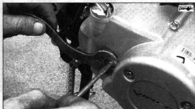
Рис. 56. Регулировка свободного хода педали переключения передач
