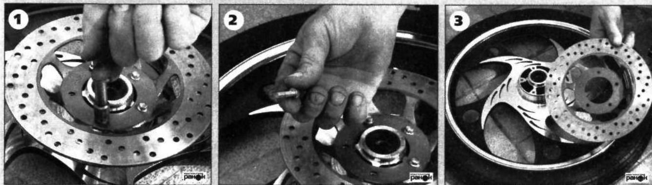
Рис. 52. Снятие тормозного диска
