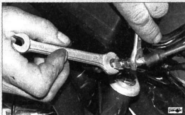
Рис. 59. Регулировка троса акселератора («газа»)
