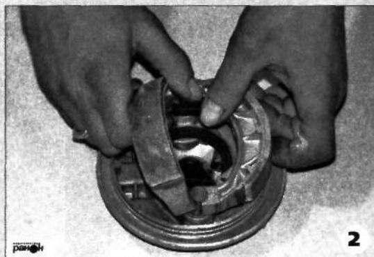
Рис. 48. Замена задних тормозных колодок
