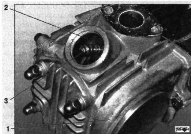
Рис. 28. Расположение регулировочного винта зазоров клапанов: 1 – головка цилиндра; 2 – регулировочное отверстие; 3 – регулировочный винт
