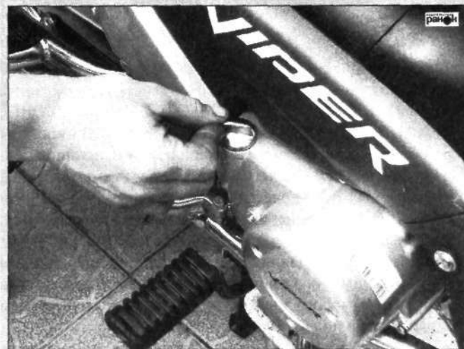
Рис. 24. Проверка уровня моторного масла
