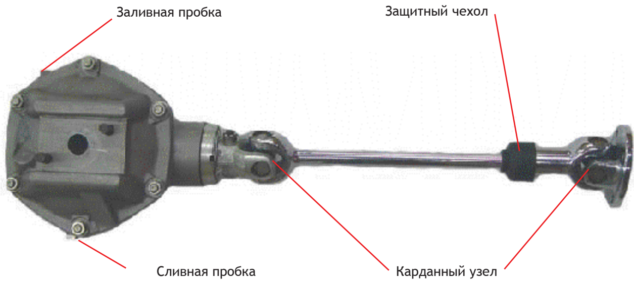
Главная передача в сборе (до 2006 года)
