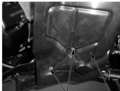
Болт 1 Болт 2 Переднее правое внутреннее крыло
