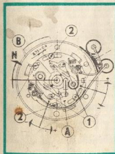
Рис. 19 — Регулировка опережения зажигания
