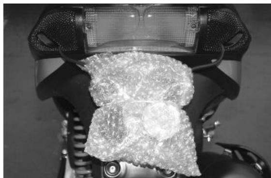
Per facilitare la rimozione delle griglie di supporto, rimuovere il trasparente gruppo ottico posteriore
