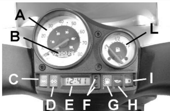
Per rimuovere lo strumento agire sulle tre viti, disconnettere il giunto riporto contachilometri **O**, i connettori **M** e **N**.
