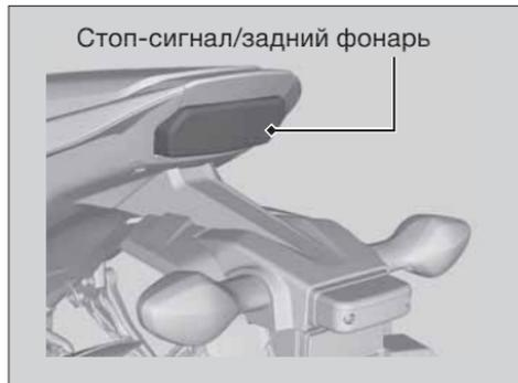
Функцию стоп-сигнала и заднего фонаря выполняет комбинированный фонарь на светодиодных элементах.
