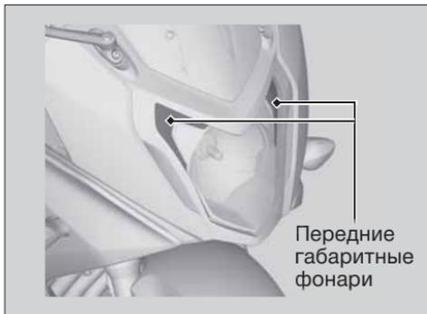
Передние габаритные фонари представляют собой комбинированные фонари на светодиодных элементах.
