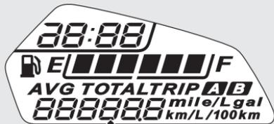
Одометр [TOTAL], счетчик пробега за поездку [A/B], указатели мгновенного и среднего расхода топлива.
