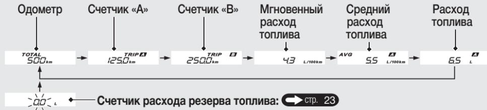
Средний расход топлива высчитывается согласно данным счетчика пробега «А».
