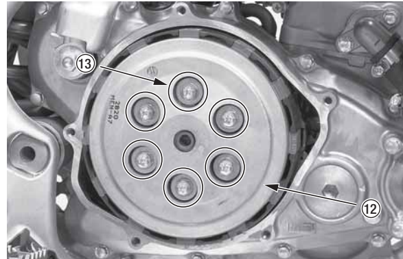
(12) прижимной диск сцепления (13) пружины сцепления и болты
