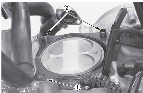
(1) прокладка цилиндра (2) установочные штифты
