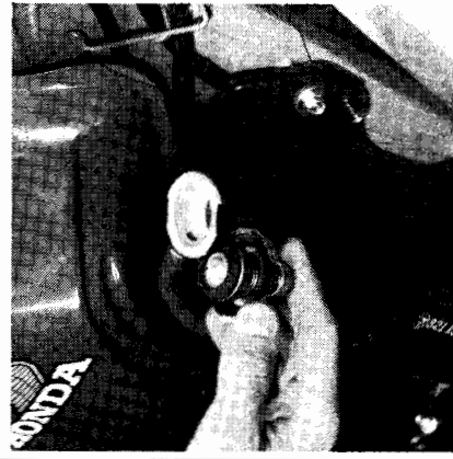
PHOTO 7 : Bouchon du radiateur des MTX 125/200 R après dépose du cache avant droit (Photo RMT)
