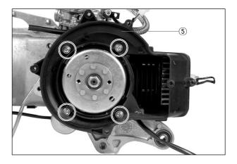
• Install the cooling fan ⑥.
