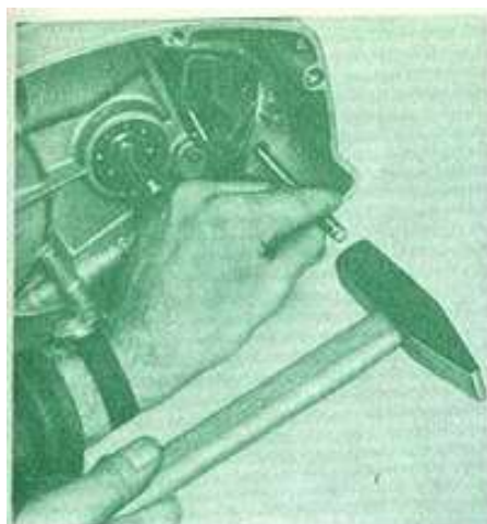
Рис. 234. Снятие задней центровочной втулки на двигателе мод. 634 (расположена внутри картера)
