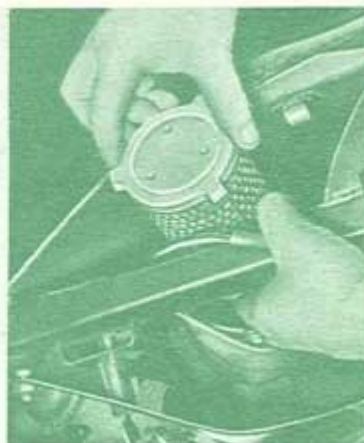
Рис. 80. Установка фильтрующего элемента в глушитель шума впуска с правой стороны трубки рамы
