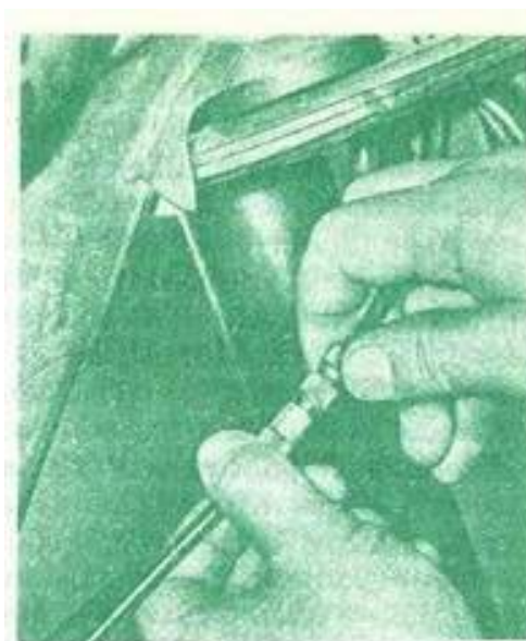
Рис. 125. Регулировка длины оболочки троса сцепления посредством штуцера, расположенного под рулевой колонкой
