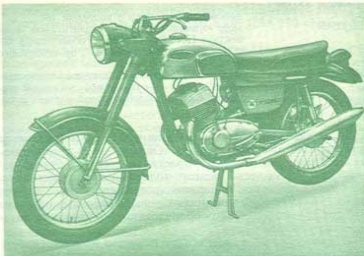
Рис. 17. Мотоцикл ЯВА-350 «Ойлмастер» мод. 362/00 (масляный насос расположен под левой крышкой картера двигателя)
