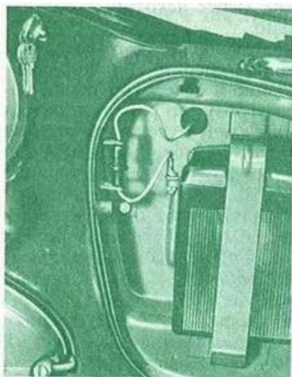
Рис. 166. Предохранитель, установленный в корпусе около аккумуляторной батареи (старые модели мотоциклов)
