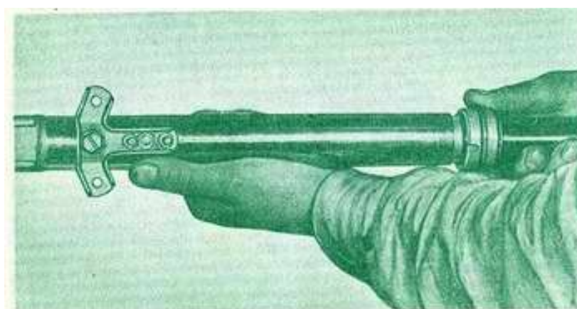
Рис. 300. Навинчивание накладной гайки на подвижный наконечник надетый на втулки
