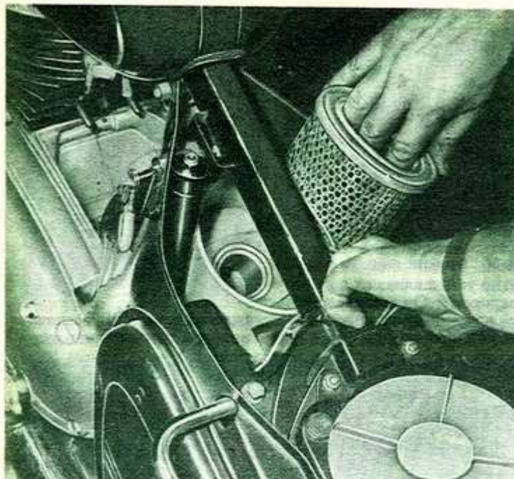
Рис. 82. Снятие фильтрующего элемента мотоциклов ЯВА-250 моделей прежних выпусков
