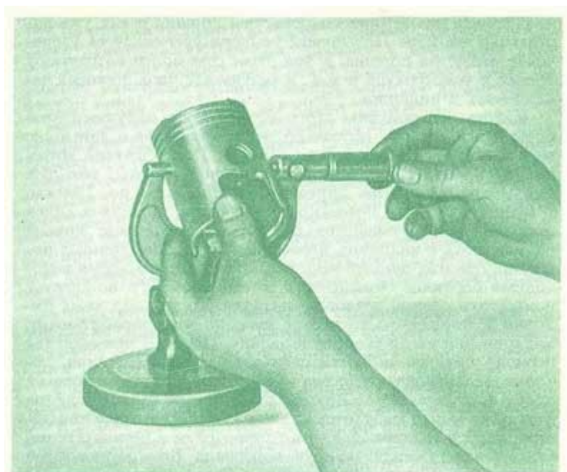
Рис. 100. Измерение диаметра поршня микрометром, закрепленным в стойке
