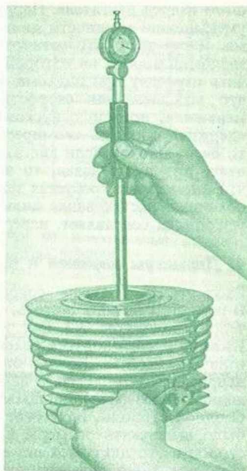
Рис. 97. Измерение диаметра цилиндра
