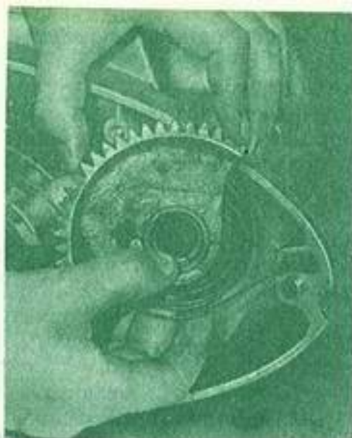
Рис. 135. Установка сектора механизма пуска в картер после фиксирования петли на конце возвратной пружины
