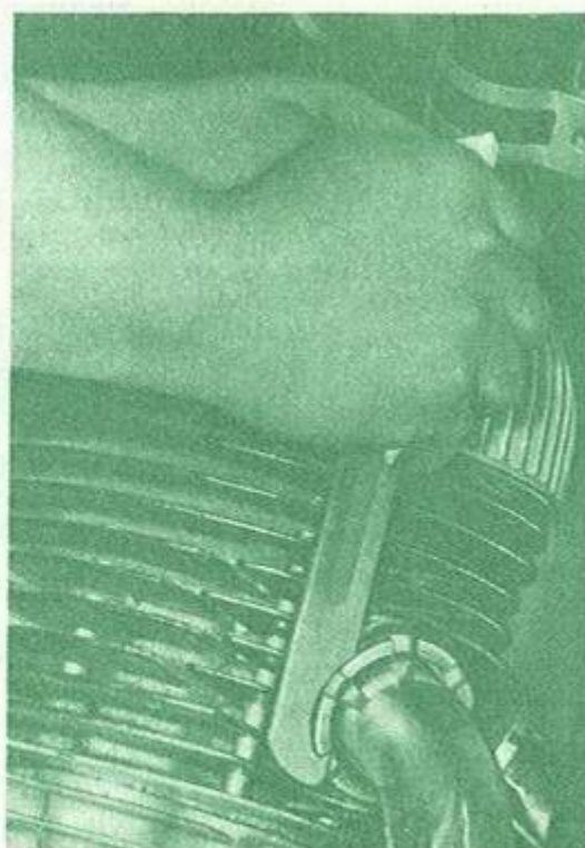
Рис. 95. Подтягивание гайки крепления выпускной трубы специальным ключом, имеющимся в наборе приспособлений для ремонта мотоцикла
