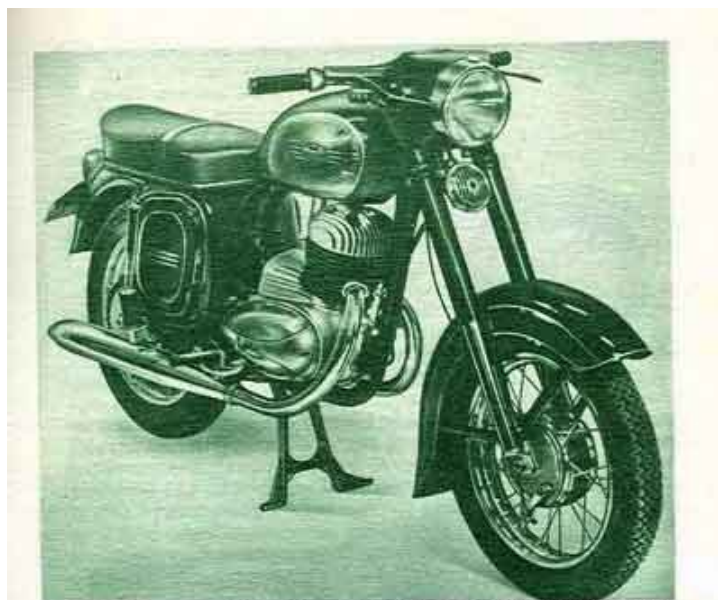
Рис. 8. Мотоцикл ЯВА-250 мод. 559/02 с модернизированным двигателем и измененной формой корпуса фары и спидометра
