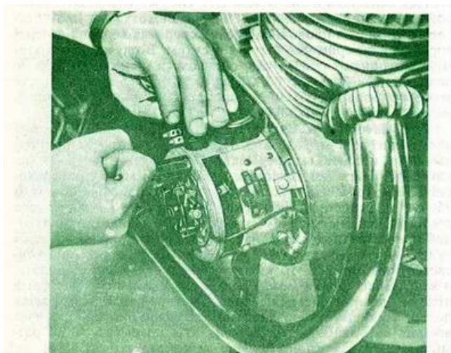
Рис. 167. Винты крепления статора генератора (должны быть всегда затянуты)
