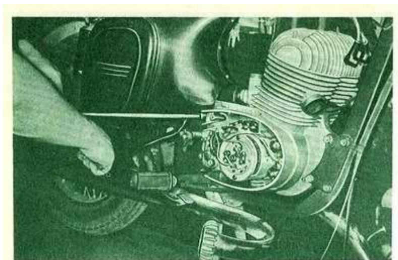
Рис. 223. Вывертывание торцовым ключом задних болтов крепления двигателя
