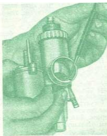
Рис. 76. Входное отверстие воздушного канала в системе холостого хода
