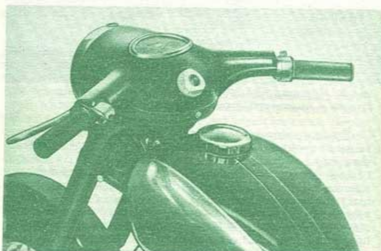
Рис. 10. Корпус фары со спидометром овальной формы и новым выключателем зажигания для мотоциклов моделей 559 и 354/06
