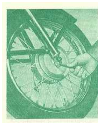
Рис. 301. Закрепление оси переднего колеса
