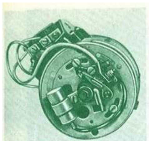
Рис. 142. Генератор постоянного тока для одноцилиндровых двигателей мотоциклов ЯВА-250
