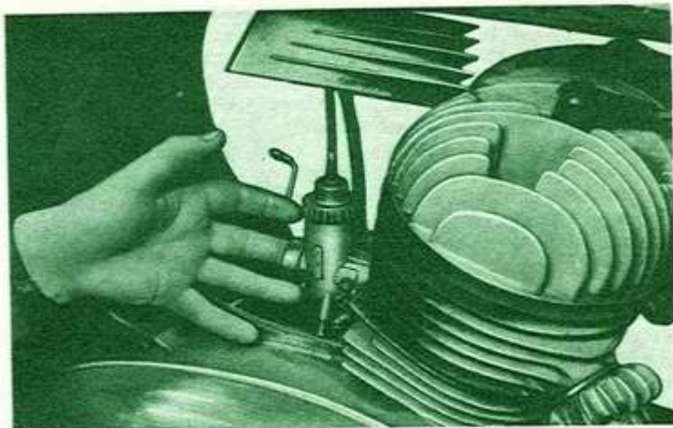
Рис. 87. Прижатие пальцем дроссельного золотника при малой частоте вращения вала двигателя для обнаружения стука золотника
