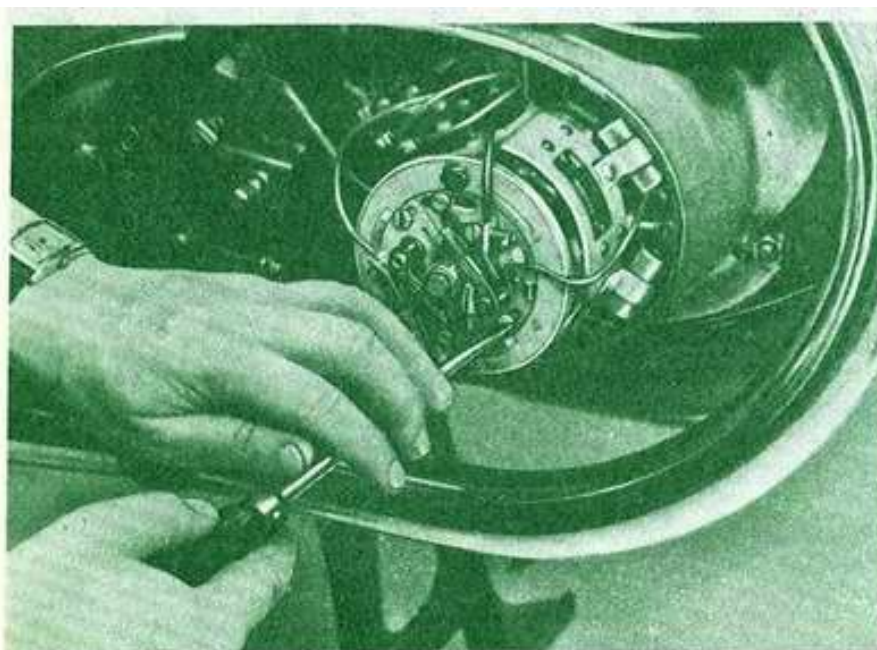
Рис. 178. Закрепление основания затяжкой обоих винтов после регулировки зазора
