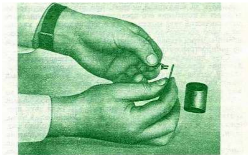
Рис. 86. Установка стопорного кольца иглы дроссельного золотника в канавку иглы
