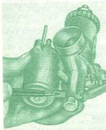
Рис. 72. Прилив для соединительного канала между нижней частью поплавковой камеры и эмульсионной трубкой
