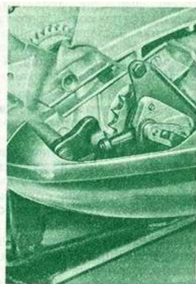
Рис. 130. Механизм выключения старой конструкции при выключенном сцеплении
