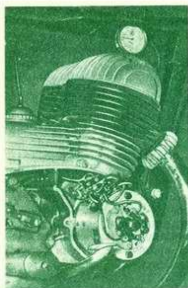
Рис. 182. Двигатель мотоцикла ЯВА-350 с установленным индикатором для определения опережения зажигания
