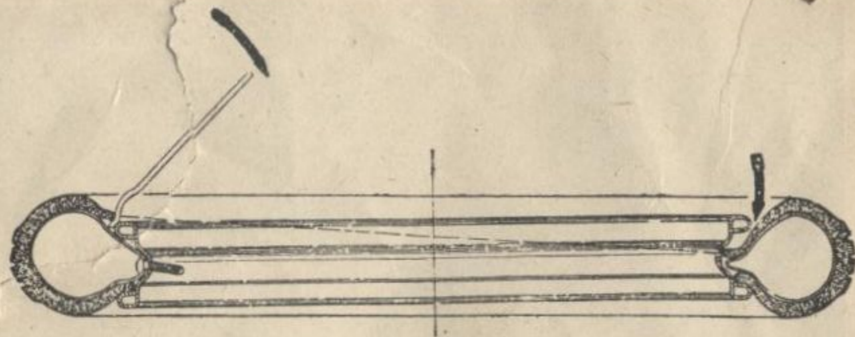
Рис. 15. Разрез обода колеса и шины.
