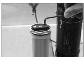
Tighten the Allen bolt.
