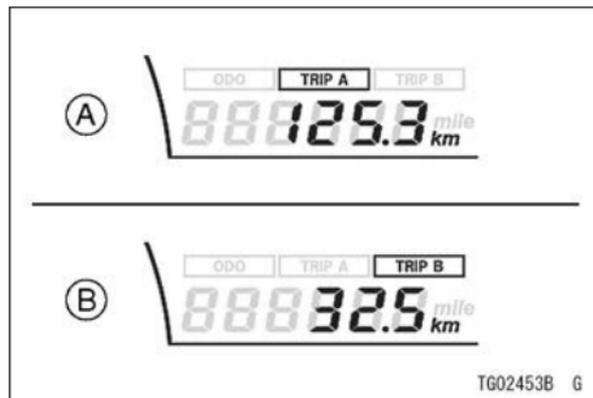
A. Счетчик суточного пробега (A)
