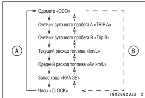
**A.** Нажатие верхней кнопки измерительного прибора или верхней кнопки
