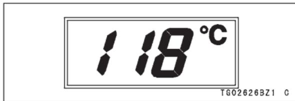
Если температура охлаждающей жидкости становится выше 120°C (248°F), отображается и начинает мигать символ «HI». Также загорается красный предупредительный индикаторный сигнал. Это предупреждает водителя, что температура охлаждающей жидкости чрезмерно высокая. Остановите двигатель и проверьте уровень охлаждающей жидкости в компенсационном бачке (только после охлаждения двигателя до приемлемой температуры).
