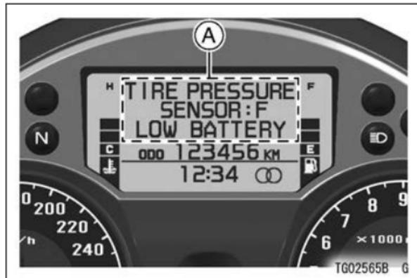
**A.** Предупреждающее сообщение о низком напряжении батарейки датчика давления воздуха в шинах (переднее колесо)
