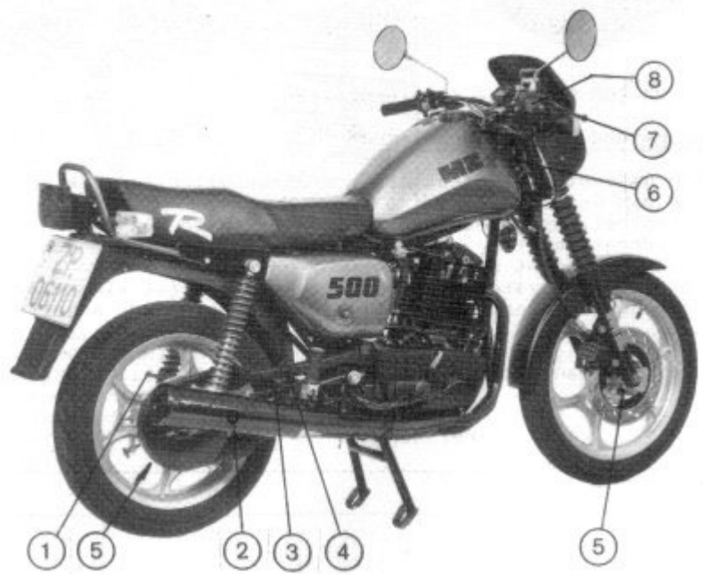
Bild 10. MZ 500 R, rechts Schmierstellen
