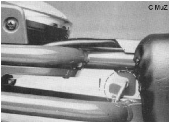
Bild 5 Sicherungsbügel (Kreis) einhängen
