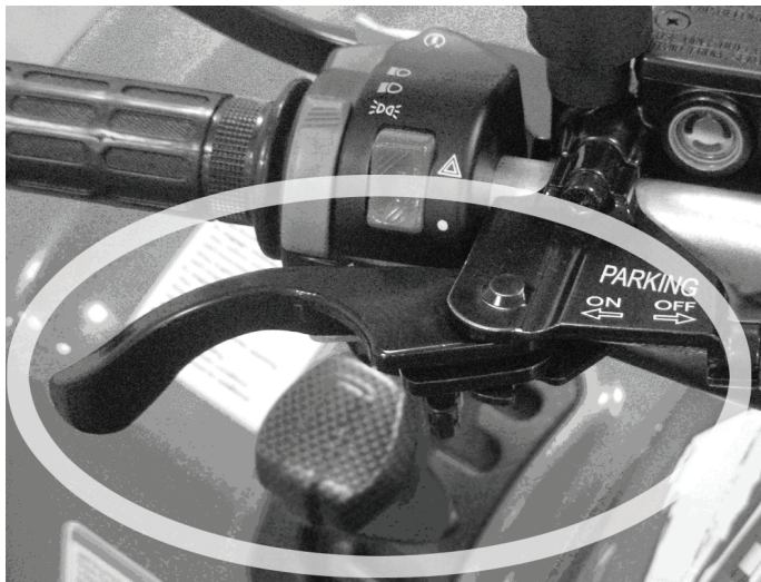
Рычаг стояночного тормоза в положении - „ ON ” (включено)
