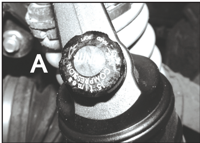
„А” - Винт регулировки жесткости амортизатора.
