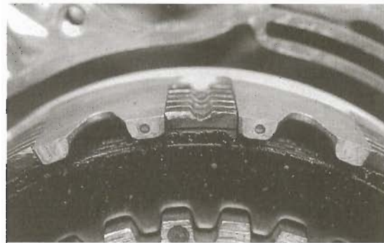
Bild 105 Einbaulage der Reibscheiben mit Nut
