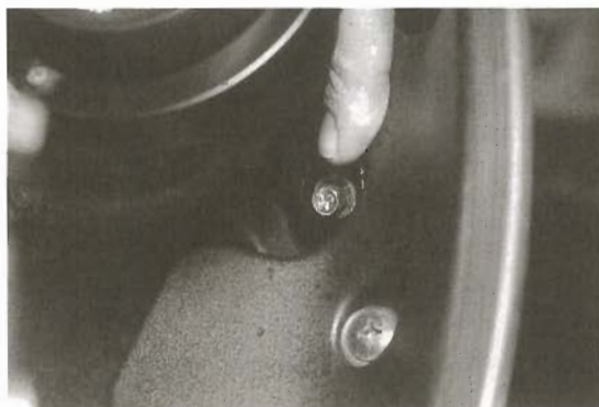
Bild 61 Seiteneinstellschraube des Scheinwerfers
