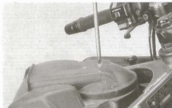
Bild 13 Befestigungsschraube des Luftfilterdeckels ausdrehen
