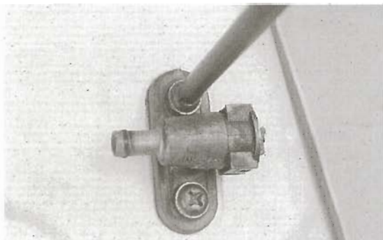
Bild 12 Befestigungsschrauben des Kraftstoffhahns ausdrehen
