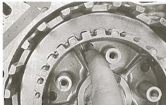
Bild 87 Überprüfen der Drahtsicherung
