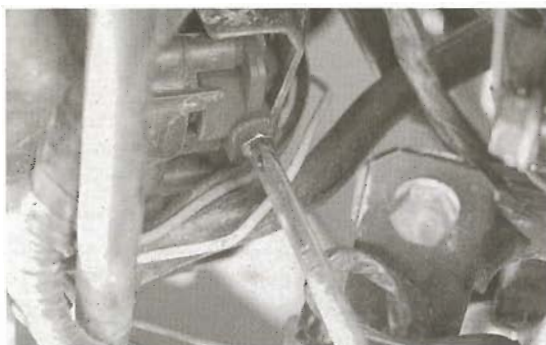
Bild 60 Höheneinstellschraube des Scheinwerfers
