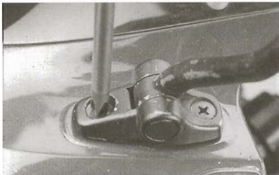
Bild 10 Verkleidungsschrauben der Spiegelbefestigung lösen
