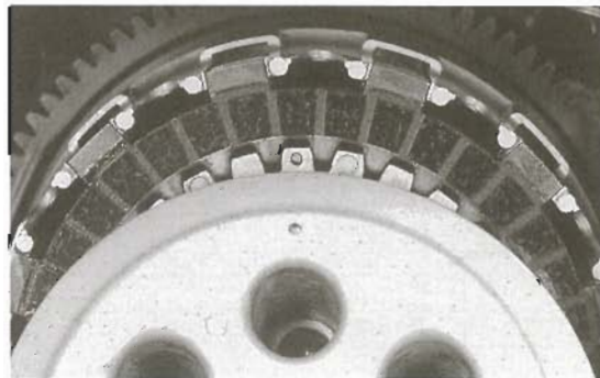
Bild 107 Punktmarkierungen müssen fluchten
