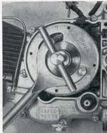
Afnemen van het vliegwiel met het speciale gereedschap voor het vasthouden, en de trekker (model C 100, C 110 en C 114).
