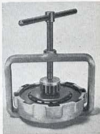
Samendrukken van de koppeling met het speciaal gereedschap (model C 110 en C 114).
