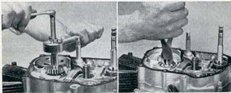
Verwijderen van de markeerpen van het distributietandwiel.
