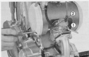
Fig. 6.2 Adjusting the Idling (S 90)
