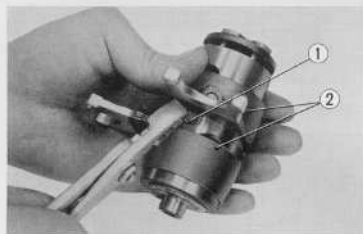
Fig. 3.98 Removing the gear shift fork ① Gear shift guide pin clip ② Gear shift fork
