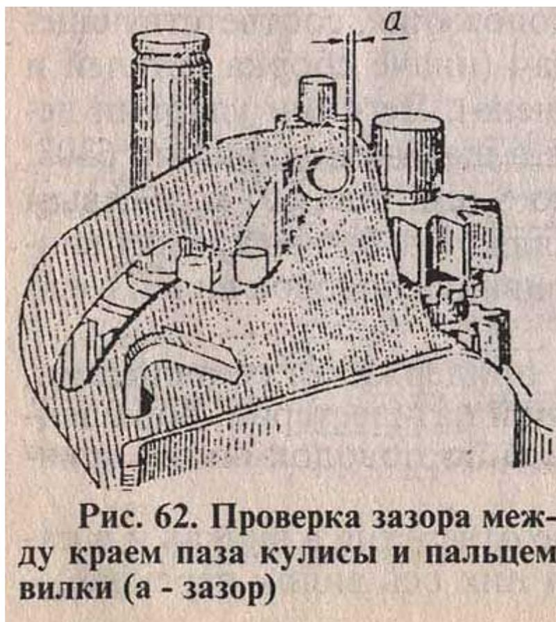
**Рис. 62. Проверка зазора между краем паза кулисы и пальцем вилки (а - зазор)**
