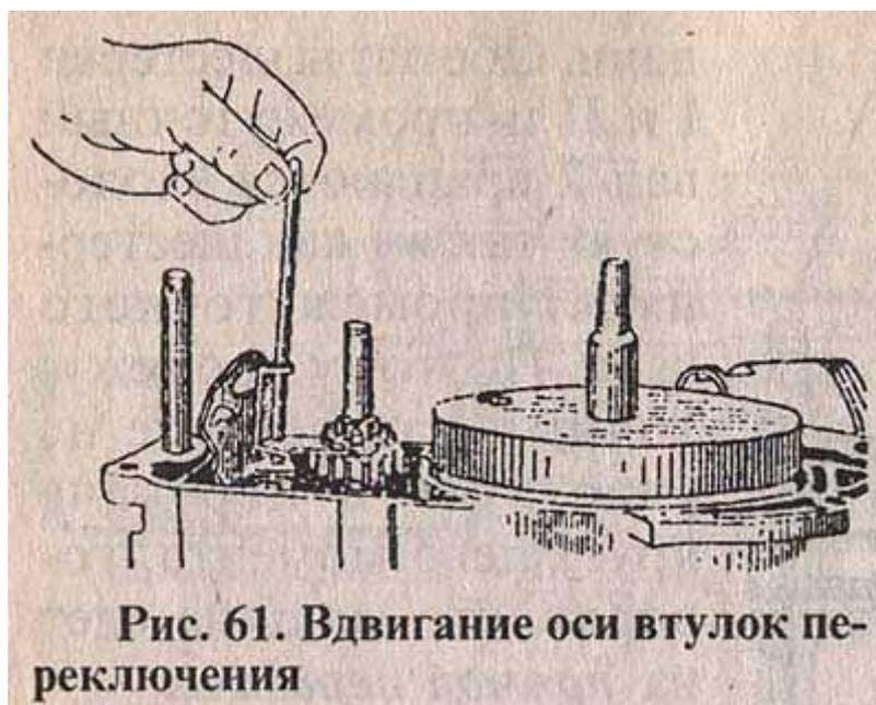
**Рис. 61. Вдвигание оси втулок переключения**
