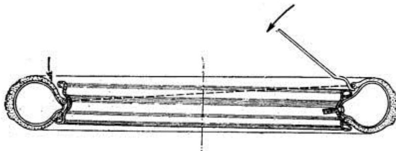
Рис. 63. Правильное положение покрышки на обод колеса при ее демонтаже
