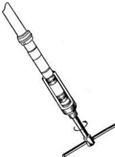
Рис. 101. Снятие бронзовых втулок частью, ввернутой в корпус неподвижной трубы пера передней амортизатора (см. стр. 128) вилки при помощи съемника
