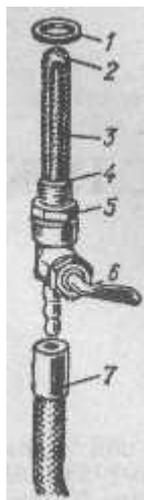
Рис. 4. Топливный краник:
