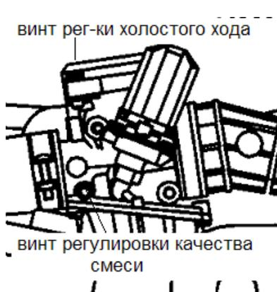
Карбюратор имеет 2 регулировочных винта – винт регулировки холостого хода и винт регулировки качества горючей смеси. Винт регулировки холостого хода находится в верхней части карбюратора, вблизи точки присоединения троса управления дроссельной заслонкой. Для получения доступа к этому винту Вам необходимо открыть внутреннюю крышку багажного ящика (если в Вашем мопеде такой крышки нет – придется снимать весь багажный ящик с сидением). Винт регулирования качества рабочей смеси
