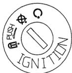
**Замок зажигания** – предназначен для включения питания системы электрооборудования мопеда, а также для блокировки руля при длительных стоянках.
