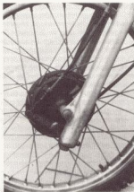
Bild 19 Bei Betätigung der Vorderradbremse bilden Brems Schlüssel und Bowdenzug einen rechten Winkel
