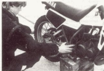
Bild 18 Prüfen der Schwingerlager
