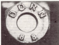
Bild 16 Der Aufdruck auf dem Schraubenkopf von Schrauben deutscher Herkunft verrät den Hersteller und Eigenschaften des Schraubenwerkstoffes
