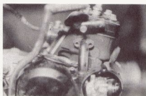
Bild 90 Der Flansch des Kühlmitteltrohres wird vom Zylinder gelöst
