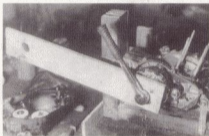
Bild 104 Selbstgebauter Gegenhalter für die Kupplungs nabe. An seiner linken Seite passt er zur Kupplung der Modelle SR 500 und XT 500.
