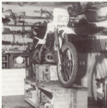
Bild 50 4 Einzelelemente, wie hier zusammengestellt, bilden eine Montagebühne
