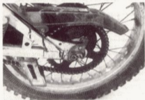
Bild 22 Kettenspanneinrichtung, Achsmuttersicherung und hintere Kettenführung
