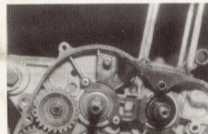
Bild 108 Das Ölbleitblech wird von nur einer Schraube gehalten (Pfeil)
