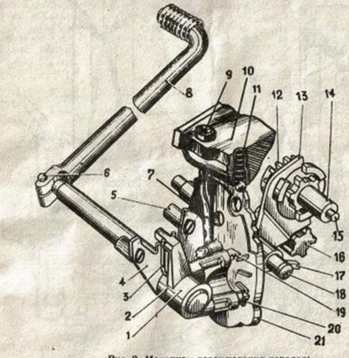
Рис. 9. Механизм переключения передач;
