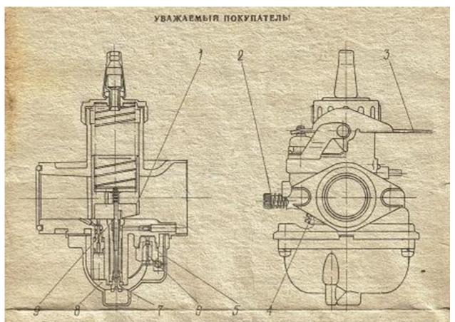
Если на Вашем мотоцикле установлен карбюратор индийского производства, то Вам необходные ознакомиться с некоторыми особенностями конструкции данного парбюратора (см. рис. 1). Карбюратор имсет четыре рабочих системы,
