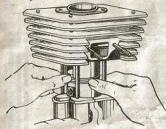
Поршневые кольца заменяйте, когда зазор в замке достигает 2,0—2,5 мм. Нормальный зазор — 0,2—0,3 мм.
