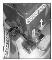
**LIFT SWITCH UP**BILGE PUMP SHOULD TURN ON
