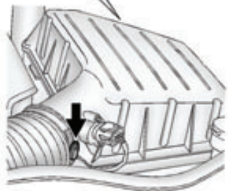
На рисунке показан корпус воздухоочистителя/воздушный фильтр двигателя 3,6 л V6 (6,2 л V8 – аналогично)
