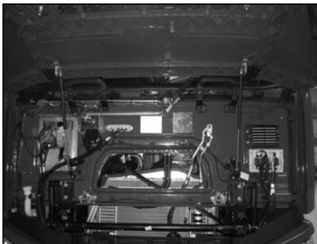
▶ Отворачивайте внешнюю панель передка вверх, оставьте внешнюю панель опирается на пневмопружину, как показано на рисунке.
