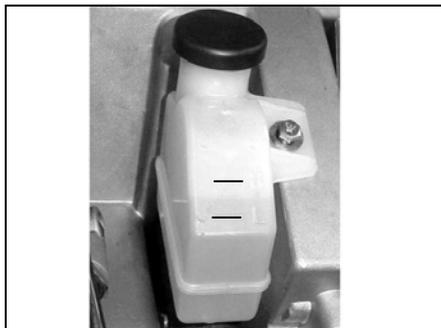
▶ Масляный резервуар сцепления расположен в левой стороне передка. Откройте внешнюю панель передка, проверьте уровень жидкости, при необходимости добавляйте гидравлическое масло сцепления, в случае обнаружения ухудшения качества тормозной жидкости, своевременно замените.
