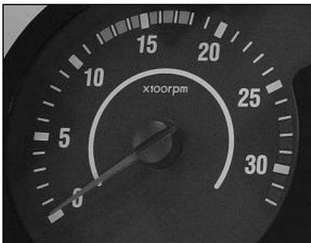
— Во время обкатки (в пределах 1000 км пробега), следует ограничивать максимальную частоту вращения двигателя ниже 1500 об/мин, также предотвращать ненадлежащую эксплуатацию.
