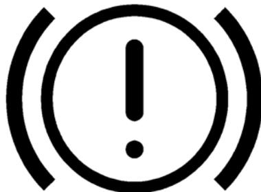
**Сигнальная лампа неисправности тормозной системы**
