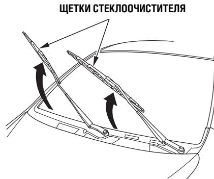
1. Поднимите рычаги стеклоочистителя в верхнее фиксируемое положение. В первую очередь поднимайте рычаг стеклоочистителя, расположенный напротив водительского сиденья.
