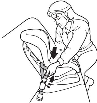
Для того чтобы установить и зафиксировать детское защитное устройство на центральном месте заднего сиденья с помощью поясного ремня безопасности, проденьте лямки поясного ремня через специальные элементы защитного устройства, предназначенные для этого в соответствии с инструкцией производителя, и вставьте скобу в замок.
