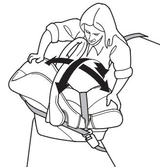
7. Проверьте надежность крепления детского защитного устройства на месте, попробовав сдвинуть его в различных направлениях, и убедитесь в том, что оно остается неподвижным. Если детское защитное устройство при этом перемещается, повторите описанные выше монтажные операции заново.
