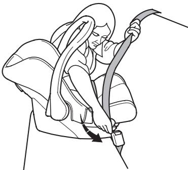
2. Пропустите ремень безопасности через элементы детского защитного устройства в соответствии с рекомендациями изготовителя устройства и вставьте пряжку ремня в замок.
