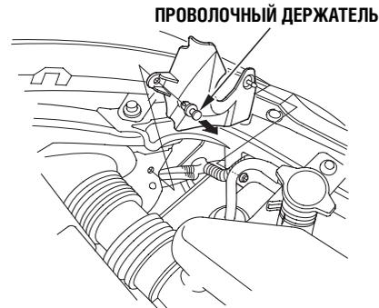
1. Откройте капот. Фонарь переднего указателя поворота расположен рядом с лампой фары. С помощью отвертки с плоским жалом снимите фиксатор щитка фары и отогните щиток.
