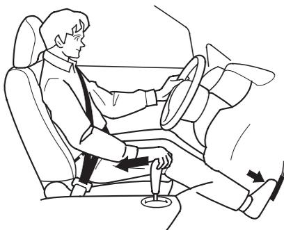
Для того чтобы включить рычаг селектора диапазонов в положение Р (Стоянка), необходимо также нажать на кнопку фиксатора. Во избежание поломки трансмиссии, включайте рычаг в положение Р (Стоянка) только после полной остановки автомобиля. Чтобы извлечь ключ из замка зажигания, рычаг селектора должен находиться в положении Р (Стоянка)
