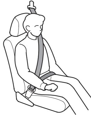
Максимально опустите поясную лямку ремня, лежащую на бедрах. Потяните за плечевую ветвь ремня, чтобы выбрать слабинку и добиться плотного прилегания ремня к телу. Правильное положение нижней лямки ремня обеспечит при аварии безопасное для вашего здоровья восприятие инерционной нагрузки прочными тазовыми костями.
