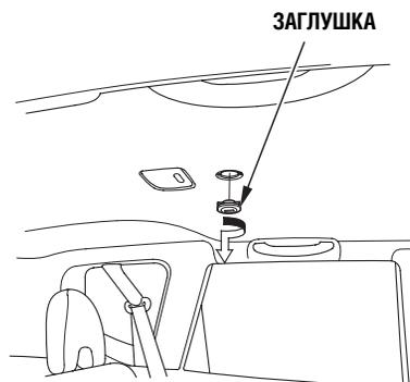
4. С помощью отвертки или монеты снимите заглушку, которая расположена в центральной части потолка и закрывает гнездо под ключ.
