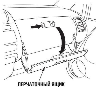
Откройте крышку перчаточного ящика, потянув за ручку в направлении, указанном стрелкой. Для того чтобы закрыть перчаточный ящик, просто захлопните крышку.
