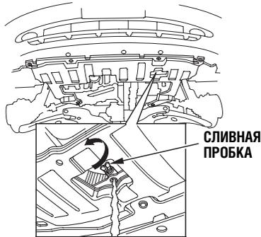
4. Ослабьте сливную пробку, которая расположена снизу радиатора. При этом охлаждающая жидкость будет сливаться через окно в нижнем грязезащитном кожухе.
