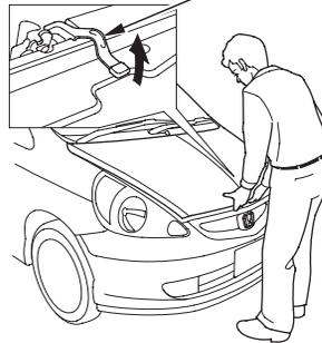
2. Стоя спереди автомобиля, просуньте пальцы руки под переднюю кромку капота. Нащупайте рукоятку дополнительной защелки капота, которая находится в центре, над эмблемой "Н". Нажмите на рукоятку вверх, чтобы отвести защелку и освободить капот. Поднимите капот.
