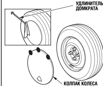
На некоторых вариантах оборудования автомобиля необходимо с помощью удлинителя домкрата снять колпак колеса.
