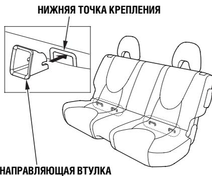
При установке детского фиксирующего устройства соблюдайте все рекомендации изготовителя устройства.
