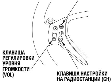
Кнопка и две клавиши, расположенные на ступице рулевого колеса, позволяют водителю управлять основными функциями аудиосистемы, не отрывая рук от рулевого колеса.
