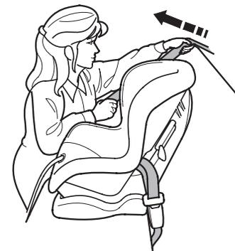
3. Для регулировки слабину натяжения ремня инерционной катушкой и надежной фиксации защитного устройства медленно полностью вытяните плечевую ветвь ремня.
