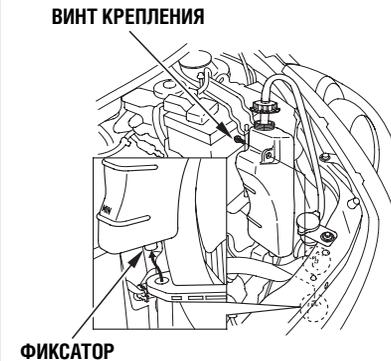
6. Снимите крышку расширительного бачка и выверните с помощью гаечного ключа винт крепления. Снимите расширительный бачок, переместив его вверх. И слейте из него охлаждающую жидкость в подходящую емкость.
