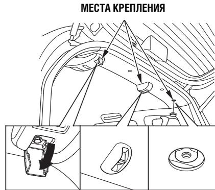
На вашем автомобиле предусмотрено три места, оснащенных креплениями специальной конструкции для установки средств фиксации детей. Они расположены на потолке рядом с проемом двери багажного отделения
