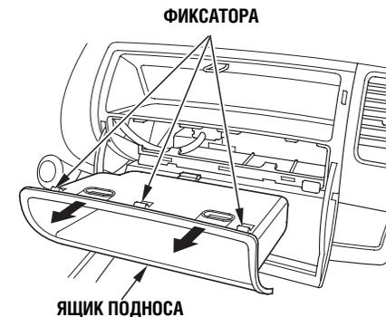
Воздушный фильтр системы вентиляции салона находится за перчаточным ящиком. Для замены фильтра выполните следующие действия:
