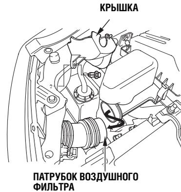
5. Чтобы снять расширительный бачок и слить из него охлаждающую жидкость, снимите патрубок воздушного фильтра и крышку (см. стр. 323).
