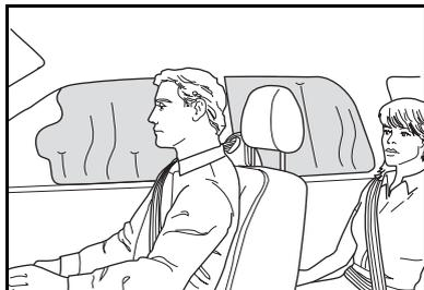
Ваш автомобиль также может быть оборудован двумя установленными на потолке боковыми шторками безопасности, которые могут сработать при боковом ударе или переворачивании автомобиля. Эти подушки предназначены для дополнительной защиты водителя, переднего пассажира и пассажиров, находящихся на задних крайних сиденьях.
