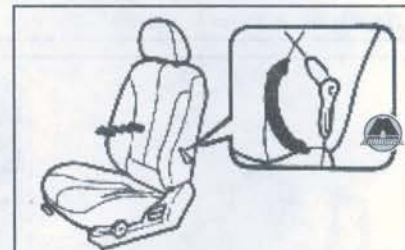
Расположение ручки и направления регулировки поясничного подпора
