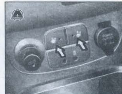
Расположение ручки и направления регулировки по высоте подушки сиденья водителя
