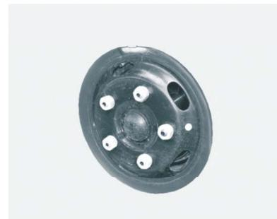
Отпустите колесные гайки и открутите их пальцами. Снимите колесо со шпилек и уложите его плашмя, чтобы оно не укатилось. Чтобы надеть на ступицу, возьмите запасное колесо, совместите отверстия со шпильками и насадите колесо на них. Если не получается, слегка постучите по колесу и совместите верхнее отверстие в колесе с верхней шпилькой. Затем покачайте колесо взад и вперед, пока оно не сядет на другие шпильки.
