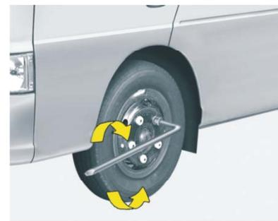
Перед поднятием автомобиля колесные гайки следует немного ослабить. Для этого вращайте рукоятку ключа против часовой стрелки. При этом убедитесь, что головка плотно сидит на гайке и не соскочит с нее. Затем, взявшись за ключ ближе к концу рукоятки, надавите на него с ровным усилием. Гайки пока не снимайте. Лишь отпустите их на пол-оборота.
