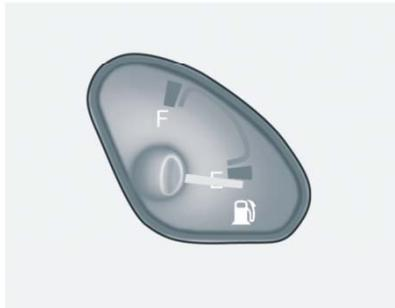
Стрелка расходомера показывает приблизительный уровень топлива в топливном баке. Объем топливного бака указан в разделе 8.
