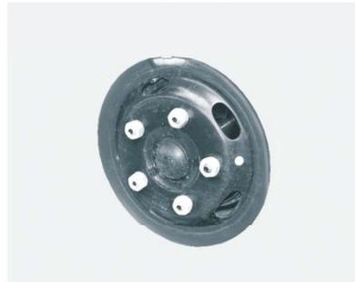
Чтобы установить колесо, придерживайте его на шпильках, наденьте колесные гайки на шпильки и затяните от руки. Покачайте колесо и убедитесь, что оно полностью село, затем снова затяните гайки от руки как можно сильнее.
