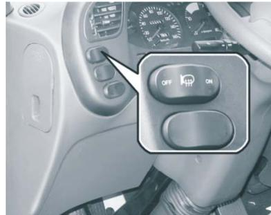
Чтобы обогреть поверхность наружного зеркала заднего вида, нажмите соответствующий переключатель. Обогрев поверхности наружного зеркала заднего вида позволяет предотвратить образование на ней конденсата или инея, что позволит улучшить качество заднего обзора при экстремальных погодных условиях. Нажмите переключатель еще раз, чтобы выключить обогреватель. Обогреватель наружного зеркала заднего вида автоматически выключается через 15 минут после включения.
