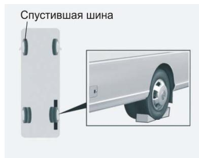
Установите колодки под колеса диагонально, напротив спущенной шины во избежание сдвига автомобиля при его подъеме домкратом.
