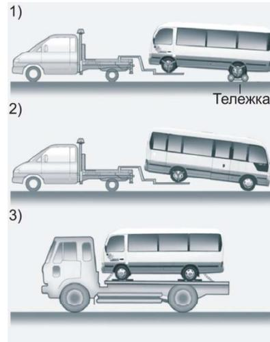
Ваш автомобиль можно буксировать грузовиком с подъемом колес (1), (2) или на грузовой платформе (3).
