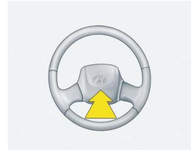
Для того чтобы задействовать звуковой сигнал, нажмите на центральную часть рулевого колеса.
