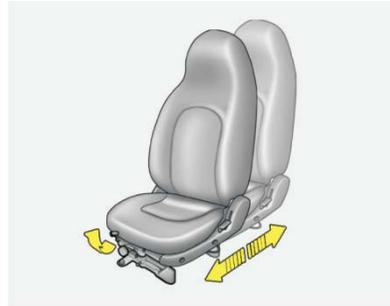
Чтобы переместить сиденье вперед или назад, потяните рычажок фиксации вверх. Это позволит перемещать сиденье по направляющей вперед или назад в нужное положение. После того как вы найдете нужное положение сиденья, зафиксируйте рычажок и сдвиньте сиденье вперед или назад по направляющей до фиксации в нужном положении.
