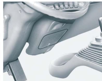
Если в вашем автомобиле перестают работать какие-либо осветительные приборы или другое дополнительное электрооборудование, причиной может быть перегоревший плавкий предохранитель. Если предохранитель сгорел, вы увидите, что металлическая перемычка внутри предохранителя расплавилась. Если вы полагаете, что перегорел какой-либо предохранитель, выполните следующие операции:
