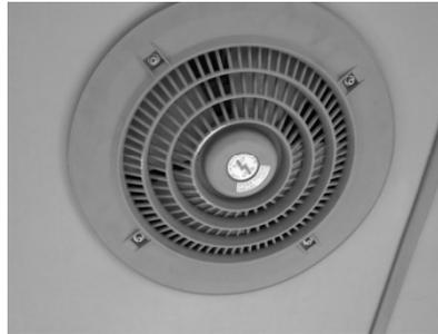
На автобусе, предназначенном для перевозки детей, форточки на боковых окнах пассажирского салона отсутствуют, а вентиляция обеспечивается двумя вентиляторами, установленными на крыше.
