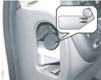
Уровень тормозной жидкости в бачке следует проверять регулярно. Уровень должен находиться между рисками «MIN» и «MAX», нанесенными на боковой поверхности бачка. Если уровень находится на риске «MIN» или ниже, осторожно долейте жидкость и доведите ее уровень до риски «MAX». Не переливайте.
