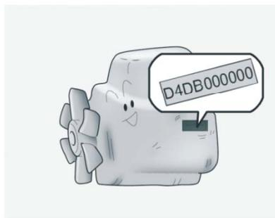
Номер двигателя выбит на блоке двигателя, как показано на рисунке.
