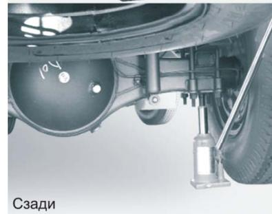
Основание домкрата должно стоять на твердом, ровном грунте. Устанавливать домкрат следует, как показано на рисунке.
