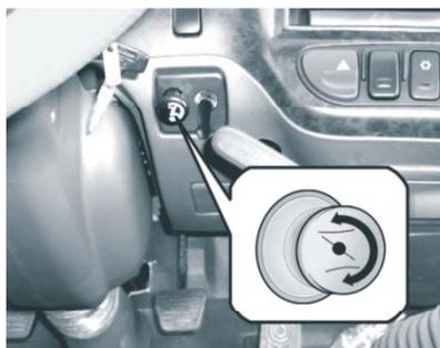
При очень низкой температуре окружающей среды или при необходимости разогреть двигатель, поверните эту ручку по часовой стрелке так, чтобы двигатель начал работать ровно. После завершения прогрева двигателя поверните эту ручку до упора против часовой стрелки.
