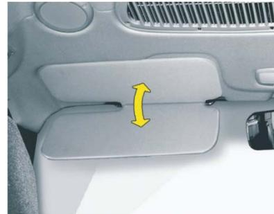
Автобус производства ТагАЗ оборудован солнцезащитными козырьками, создающими для водителя и пассажира на переднем сидении фронтальную или боковую тень. Чтобы снизить действие ослепляющего света или защититься от прямых солнечных лучей, опустите солнцезащитный козырек.
