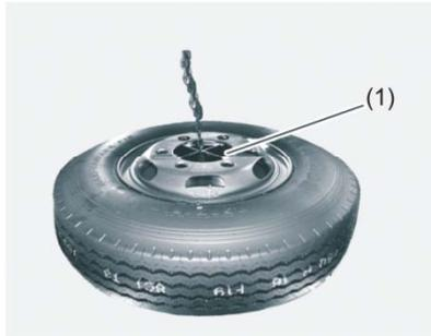
2. Чтобы установить колесо, положите его выпуклой стороной колесного диска вверх, закрепите подвесной кронштейн (1) в отверстии колесного диска и вращайте коленчатую рукоятку по часовой стрелке, наматывая цепь.
