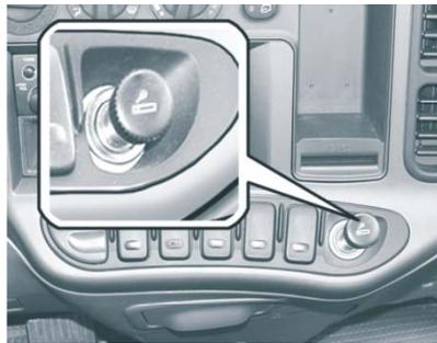
Прикуриватель работает, если ключ зажигания находится в положении «ACC» (Вспомогательное положение) или «ON» (Включено). Чтобы использовать прикуриватель, утопите его до упора в разъем. Когда нагревательный элемент разогреется, прикуриватель автоматически выскочит в исходное положение. Не удерживайте прикуриватель в утопленном положении. Это может привести к повреждению нагревательного элемента и создать пожароопасную ситуацию.
