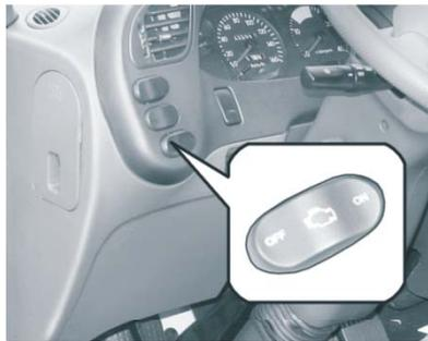
Для того чтобы облегчить пуск двигателя в холодную погоду, нажмите переключатель холодного пуска двигателя, установив в положение ON (Включено). После этого загорится световой сигнал режима предпускового прогрева. Если световой сигнал режима предпускового подогрева не горит, запустите двигатель. После успешного пуска двигателя, нажмите этот переключатель еще раз, чтобы установить его в положение OFF (Выключено).
