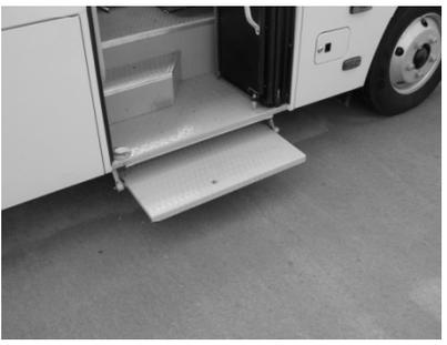
Для обеспечения безопасной посадки и высадки пассажиров, на автобусе предназначенном для перевозки детей установлена дополнительная ступенька под служебной дверью
