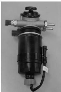
После слива воды или замены фильтрующего элемента, необходимо произвести удаление воздуха из топливной системы с помощью насоса ручной подкачки. Если этого не сделать, двигатель может работать нестабильно из-за попадания воздуха в топливную систему.
