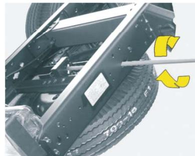
1. Чтобы освободить запасное колесо, вставьте рукоятку для съема запасного колеса в отверстие держателя запасного колеса и поверните против часовой стрелки. Снимите колесо с кронштейна.
