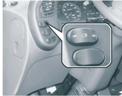
Чтобы включить задние противотуманные фары, нажмите этот переключатель. Они загораются, когда ключ зажигания установлен в положение «ON».
