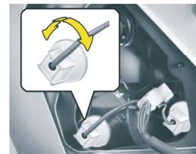
1. Отделите разъем от блока, поворачивая его против часовой стрелки до тех пор, пока фиксатор разъема не совпадет с прорезью на блоке.
