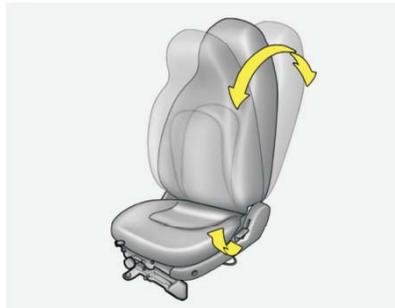
Чтобы откинуть спинку сиденья, наклонитесь вперед, для освобождения ее от давления веса вашего тела, потяните вверх рычажок изменения угла наклона спинки сиденья, который расположен на внешнем крае сиденья. Затем откиньтесь назад так, чтобы задать нужный угол наклона. Чтобы зафиксировать спинку в выбранном положении, отпустите рычажок изменения угла наклона спинки сиденья.
