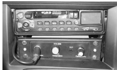
ТГУ-006 предназначено для передачи устной информации от водителя в салон пассажирского транспортного средства через динамики. Так же устройство предназначено для передачи устной информации от водителя, через громкоговоритель, который установлен на крыше автобуса. В устройстве предусмотрена индикация включения.
