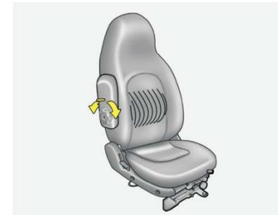
Чтобы задать нужное положение поясничной опоры, поверните регулятор положения поясничной опоры вперед. Поясничную опору можно установить в одно из двух положений
