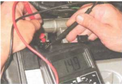
Измеряем сопротивление между выводами форсунки.
