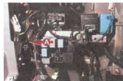
Реле системы управления, расположенное в салоне под панелью приборов: А — главное реле системы управления двигателем
