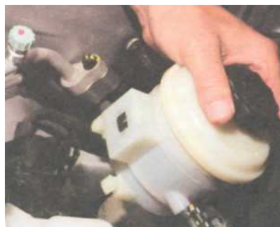
...снимаем бачок гидроусилителя рулевого управления с кронштейна...
