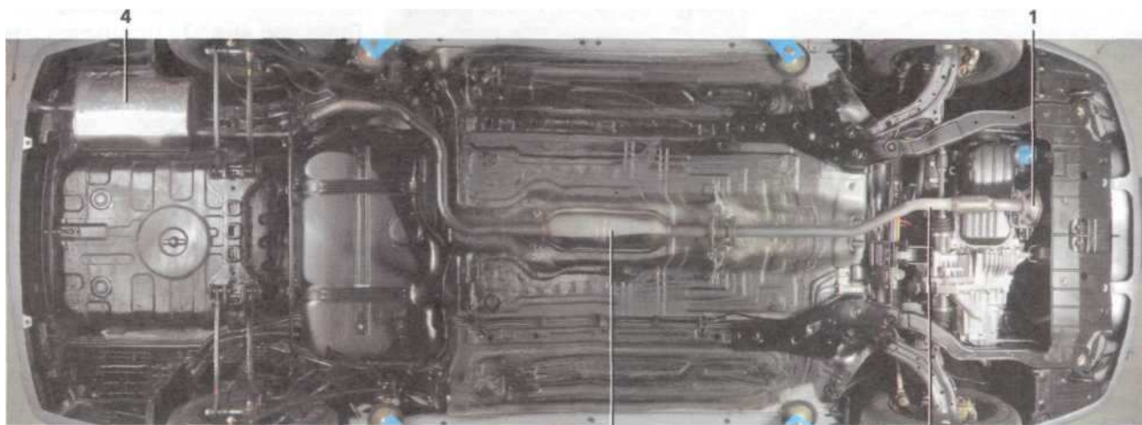
Система выпуска отработавших газов: 1 — катколлектор; 2 — промежуточная труба с металлокомпенсатором; 3 — дополнительный глушитель; 4 — основной глушитель
