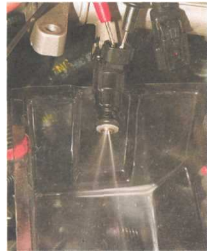
Из распылителя форсунки должны идти струи с характерным конусом распыла.
