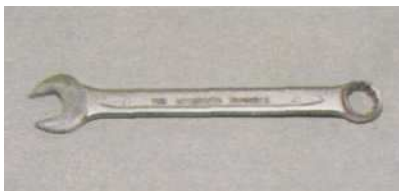
Ключ комбинированный (рожковый — накидной): 6; 7; 8; 10; 12; 13; 14; 16; 17; 19; 21; 22; 23; 24; 30; 36
