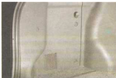
Выходит воздух из салона наружу через отверстия в боковинах багажника.
