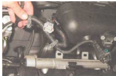
...отсоединяем жгут от топливной рампы.
