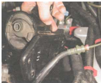
Снимаем левую опору силового агрегата.
