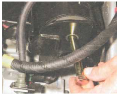
Вынимаем болт крепления опоры к кронштейну.
