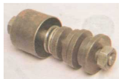
Съемник чашечный для выпрессовки и запрессовки подшипника передней ступицы
