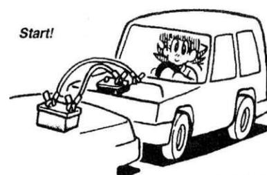
9. После запуска двигателя, отсоедините провода в обратном порядке
