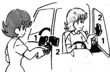
Дверные замки с электроприводом Передние двери можно открыть или закрыть с помощью ключа, либо используя кнопки; все двери запираются или отпираются одновременно.
