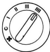
Используется для включения, выключения и выбора скорости вентилятора.
