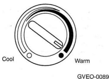
Используется для включения и выключения обогревателя, а также для выбора желаемой температуры обогрева.
