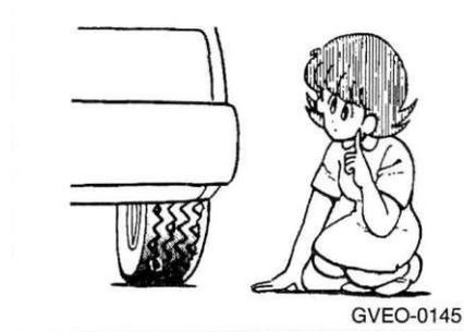
Если шины снабжены индикаторами износа, то эти индикаторы расположены в шести местах по диаметру шины. Если они стали видимыми, значит шину больше нельзя эксплуатировать. При появлении индикаторов шины необходимо заменить на новые. Убедитесь в том, что гайки крепления колес затянуты достаточно. За информацией относительно замены шин обращайтесь к разделу «Колёса».
