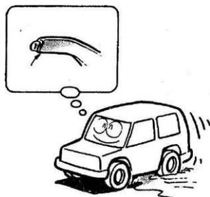
Если Ваш автомобиль оборудован турбонагнетателем, не глушите двигатель сразу после движения на высоких скоростях. Дайте двигателю поработать на холостом ходу приблизительно 60 секунд или больше, чтобы турбонагнетатель остыл.
