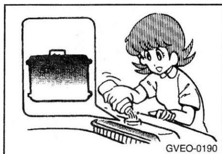
В случае необходимости добавьте охлаждающую жидкость в радиатор и расширительный бачок (за информацией обращайтесь к разделу «Сделай сам») Быстрая добавка холодной воды при горячем двигателе может привести к появлению трещин в блоке цилиндров и в головке блока цилиндров.
