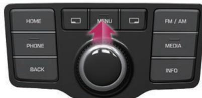
В режиме радио можно вручную искать частоты станций, вращая регулятор влево/вправо.
