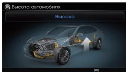
Эта функция отображает информацию о текущей высоте автомобиля. На дисплее отображается состояние клиренса автомобиля (Низко, Стандарт, Высоко).
