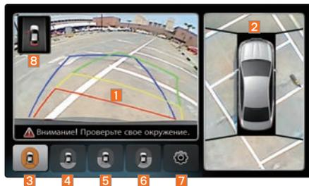
При переключении передачи в положение P или R, или при выключении кнопки BLIND, изображение с передней камеры AVM отключается.
