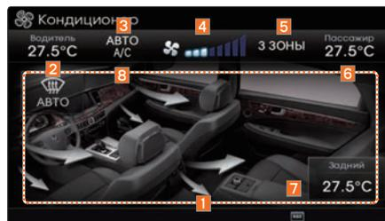
На экране отображается различная информация о микроклимате в салоне, например, температура в зоне водителя, переднего пассажира и в зоне задних сидений, режим работы вентилятора и направление обдува.
