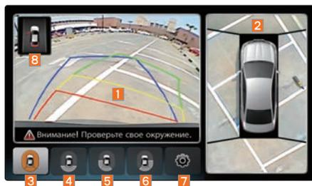
Переключение передачи из положения R в другое положение приводит к отключению изображения с задней камеры AVM.
