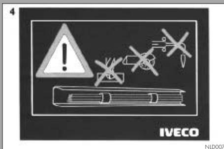
3. Отключайте отрицательную клемму от аккумулятора перед выполнением любых работ (шлифовка, сварка, замена узлов и деталей и.т.п.). Расположение таблички: под передней решеткой автомобиля или с ее внутренней стороны.
