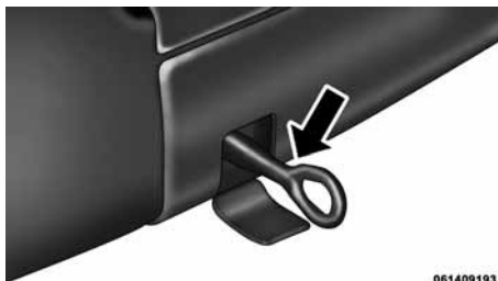
Задняя буксирная петля установлена
