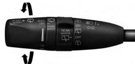
Функционирование стеклоочистителей в прерывистом режиме
