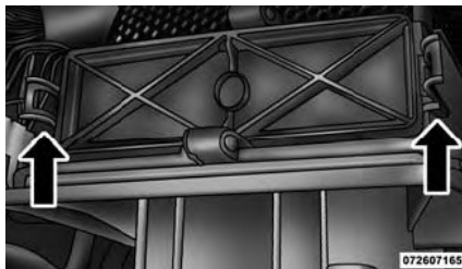
Замена воздушного фильтра системы управления микроклиматом.
