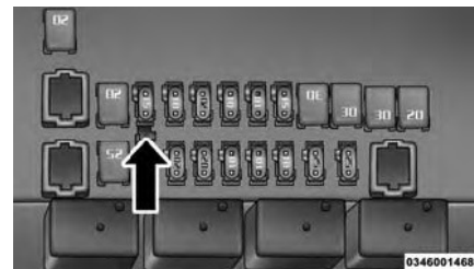
Предохранитель, защищающий цепь электрической розетки в багажном отделении
