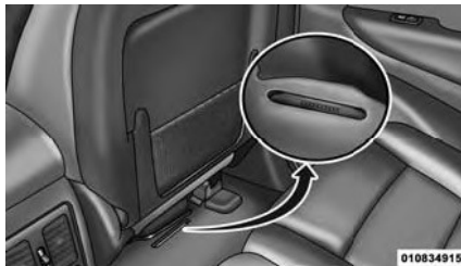
Расположение VIN-номера на правой стороне кузова
