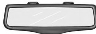
Зеркало заднего вида с автоматическим затемнением
