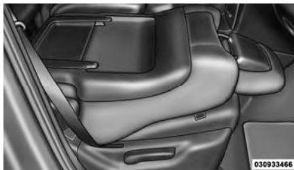
Складывающееся до горизонтального положения сиденье переднего пассажира
