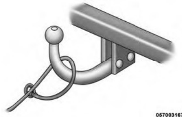
Метод крепления троса к несъемному шаровому крюку с длинной шейкой
