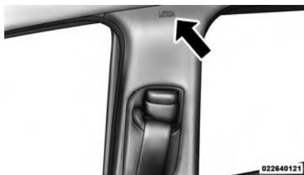
Расположение этикеток, указывающих на присутствие надувных боковых шторок безопасности
