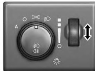
Регулятор яркости подсветки панели управления
