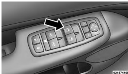
Стеклоподъемники дверей с функцией автоматического опускания стекла
