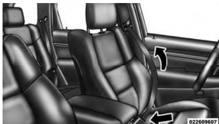
Устранение слабого натяжения ремня безопасности
