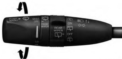
Управление очистителем ветрового стекла
