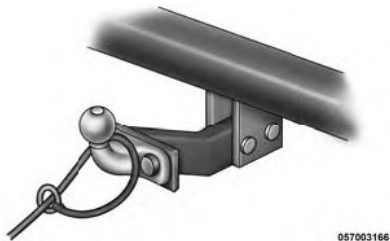
Метод крепления троса к съемному шаровому крюку с длинной шейкой
