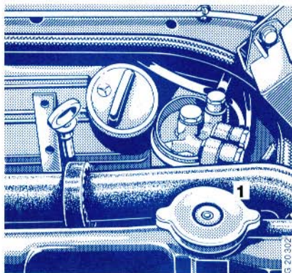
Motorklappe geöffnet 1 Einfüllöffnung — Kühlmittel
