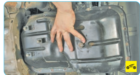
2. Снимите масляный картер (см. «Замена уплотнения масляного картера», с. 74).
