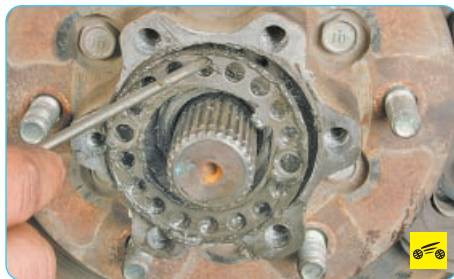
17. ...подденьте и снимите фиксирующую шайбу.
