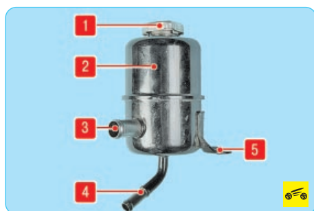
Рис. 8.3. Бачок гидроусилителя рулевого управления: 1 – крышка; 2 – корпус; 3 – патрубок питающего шланга; 4 – патрубок магистрали возврата жидкости; 5 – кронштейн крепления бачка
