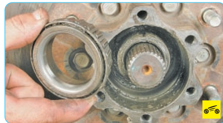
19. Легкими ударами через проставку со стороны подвески сдвиньте ступицу по оси поворотного кулака и снимите внутреннюю обойму (внутреннее кольцо с сепаратором и роликами) наружного подшипника.
