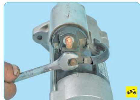
1. Отверните гайку контактного болта тягового реле...
