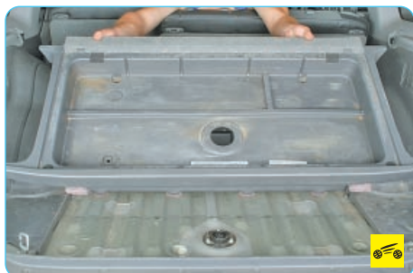
9. ...и снимите задний бокс с пола багажного отделения.
