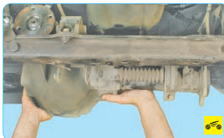
65. Снимите переднюю карданную передачу (см. «Снятие и установка передней карданной передачи», с. 141).
