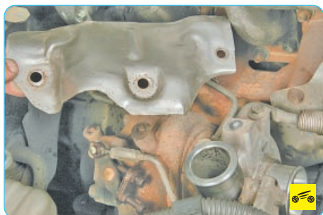
10. ...и снимите верхний термоэкран турбокомпрессора.
