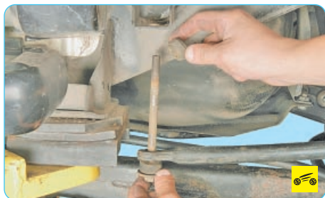
11. Снимите верхнюю резиновую втулку крепления стойки к штанге стабилизатора.
