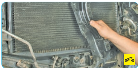
13. ...и снимите кронштейн.
