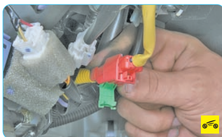
13. Откройте запорный механизм колодки...
