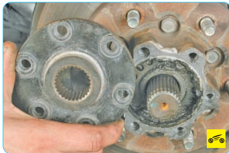
15. Снимите фланец с хвостовика привода.
