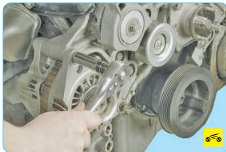
18. ...и снимите натяжное устройство.
