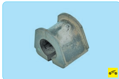
22. Осмотрите подушки штанги. Изношенные, с механическими повреждениями или признаками старения подушки замените новыми.
