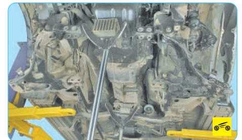
73. Надежно зафиксируйте силовой агрегат грузоподъемными механизмами.
