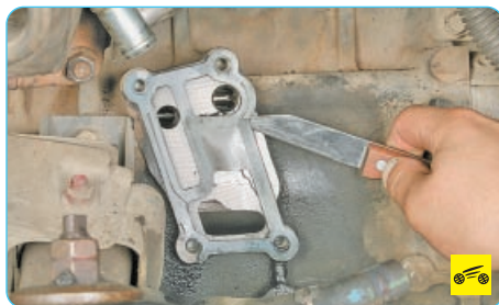
12. Подденьте отверткой или ножом...
