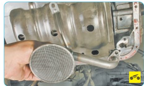
4. ...и снимите маслоприемник.
