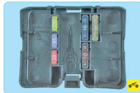
Рис. 10.2. Расположение предохранителей и реле в дополнительном монтажном блоке, установленном в моторном отсеке
