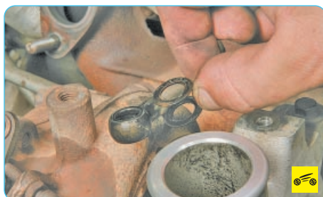
14. Снимите уплотнительные кольца с наконечника трубопровода, осмотрите и при необходимости замените их.
