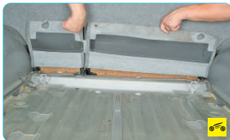
11. Откройте обивку спинки сиденья с болтов крепления петель спинки сиденья к кузову.
