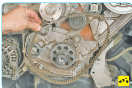
7. ...снимите ремень привода балансировочных валов.
