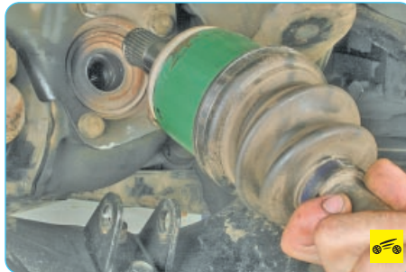
64. Снимите приводы передних колес (см. «Снятие и установка приводов передних колес», с. 151).
