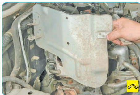
9. ...и снимите термозщит турбокомпрессора справа.
