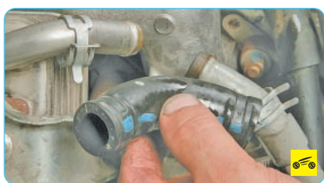
6. ...и отсоедините шланг системы охлаждения от патрубка охладителя.
