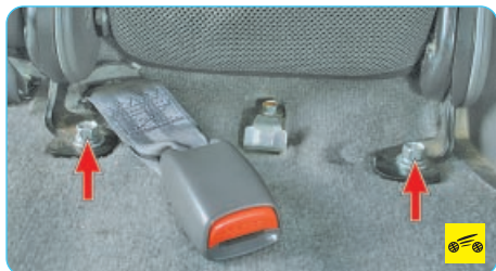
6. Выверните болты переднего крепления левой части спинки заднего сиденья к кузову.
