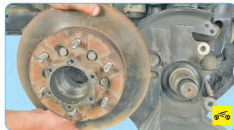
20. Снимите ступицу в сборе с тормозным диском с оси поворотного кулака.
