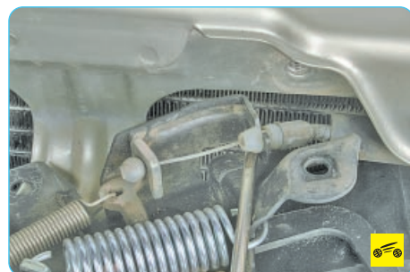
4. Подденьте отверткой и выведите из прорези на корпусе замка оболочку троса привода замка.
