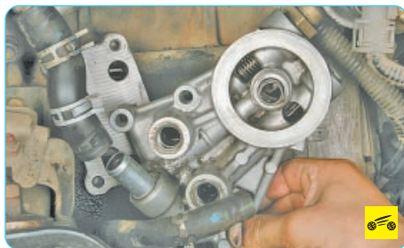
11. ...отсоедините шланг системы смазки турбокомпрессора и снимите кронштейн масляного фильтра с двигателя.
