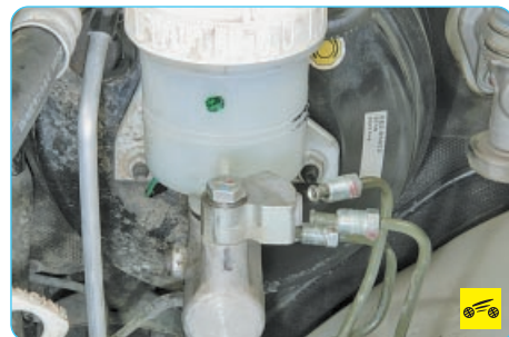
6. ...и отведите трубки в сторону.
