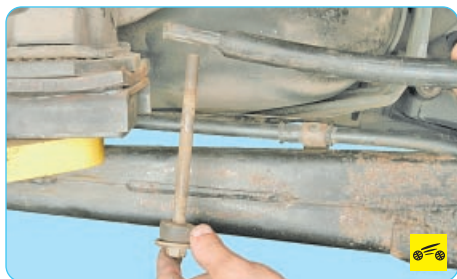
12. Извлеките болт стойки из наконечника штанги стабилизатора поперечной устойчивости задней подвески вместе с нижней резиновой втулкой и нижней опорной шайбой.
