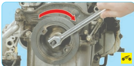
11. Удерживая коленчатый вал от проворачивания, выверните болт крепления шкива привода вспомогательных агрегатов...
