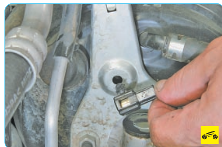
9. ...и отсоедините колодку от кронштейна.
