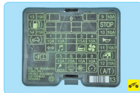
В моторном отсеке слева установлены основной А (рис. 10.1) и дополнительный Б (рис. 10.2) монтажные блоки.
