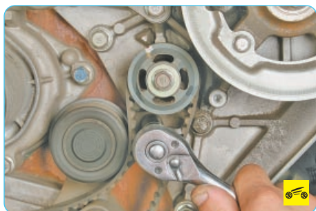
4. Ослабьте болт крепления натяжителя сверху...
