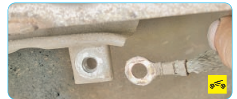
72. ...и отсоедините наконечник провода «массы» от кузова автомобиля.
