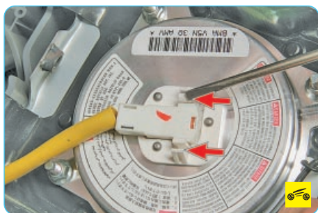
6. Подденьте отверткой два фиксатора...
