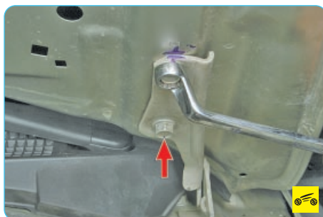
10. Удерживая капот (это должен делать помощник), выверните четыре болта крепления (по два с каждой стороны) к кронштейнам и снимите капот.
