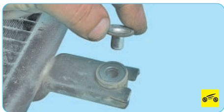
17. ...снимите распорные втулки...
