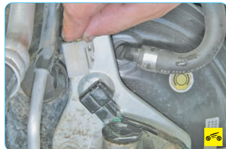
7. Отожмите фиксатор и разъедините колодки проводов датчика уровня тормозной жидкости.
