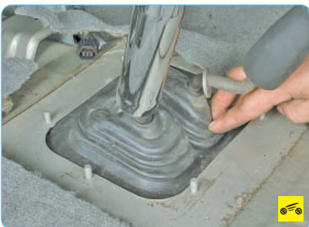
57. Снимите чехол со шпилек и протолкните его вниз.
