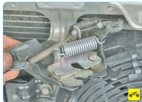
3. ...отведите замок от рамки радиатора и разверните его.
