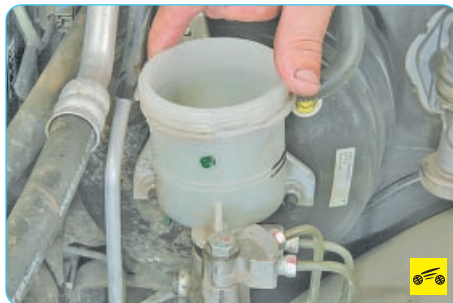
5. Отверните гайки трубок...
