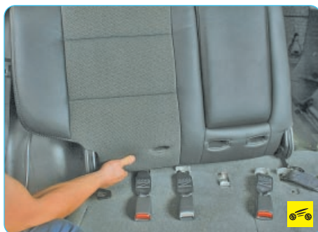
14. Аналогично снимите правую часть спинки заднего сиденья.
