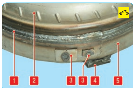
Рис. 6.7. Гидротрансформатор: 1 – сборочный сварной шов корпуса; 2 – задняя часть корпуса; 3 – балансирующие грузики; 4 – установочный кронштейн; 5 – передняя часть корпуса
