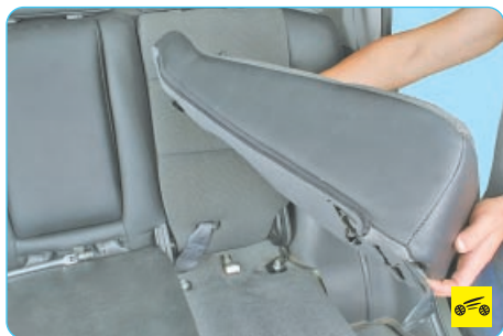
4. ...и снимите левую часть подушки.
