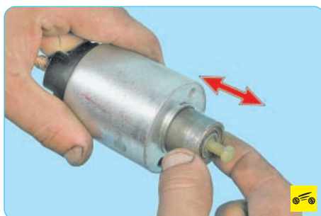
29. Проверьте, легко ли перемещается якорь тягового реле стартера, замыкаются
