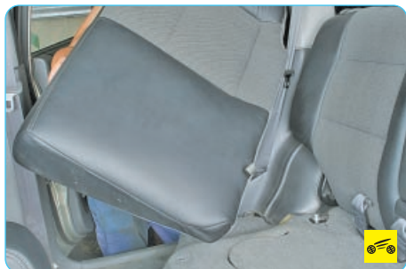
5. Аналогичным образом снимите правую часть подушки заднего сиденья.
