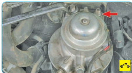
Рис. 5.8. Топливный фильтр в сборе с подкачивающим насосом: 1 – поршень подкачивающего насоса; 2 – подкачивающий насос; 3 – колодка проводов подогрева подкачивающего насоса; 4 – топливный фильтр; 5 – датчик наличия воды; 6 – пробка сливного отверстия; 7 – колодка проводов датчика наличия воды; 8 – подводящий патрубок; 9 – отводящий патрубок; 10 – болт клапана для удаления воздуха
