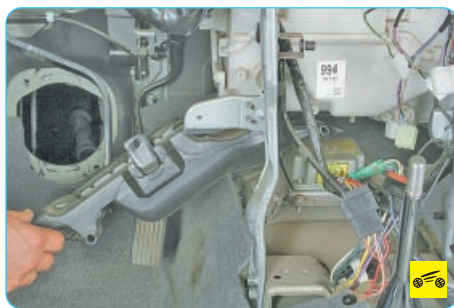
3. ...и снимите нижний воздуховод.
