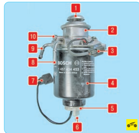
Рис. 5.8. Топливный фильтр в сборе с подкачивающим насосом: 1 – поршень подкачивающего насоса; 2 – подкачивающий насос; 3 – колодка проводов подогрева подкачивающего насоса; 4 – топливный фильтр; 5 – датчик наличия воды; 6 – пробка сливного отверстия; 7 – колодка проводов датчика наличия воды; 8 – подводящий патрубок; 9 – отводящий патрубок; 10 – болт клапана для удаления воздуха
