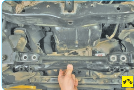
63. ...и снимите усилитель передней подвески.
