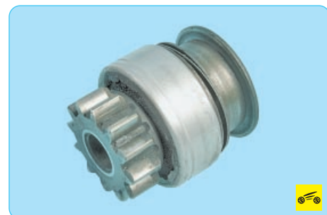
30. Проверьте муфту привода. Зубья шестерни муфты не должны иметь значительного износа. Шестерня должна легко проворачиваться относительно ступицы муфты в направлении вращения якоря и не должна проворачиваться в противоположном направлении. Если зубья шестерни изношены или повреждены либо шестерня проворачивается в обоих направлениях, замените муфту.
