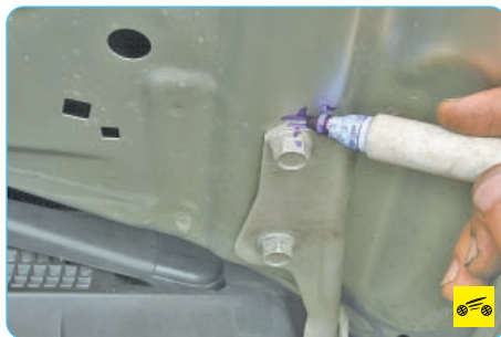
9. Если снимаете капот не для замены, пометьте его положение относительно петель, например, обведя их по контуру фломастером.
