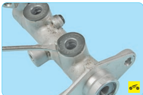
10. Снимите бачок главного тормозного цилиндра.
