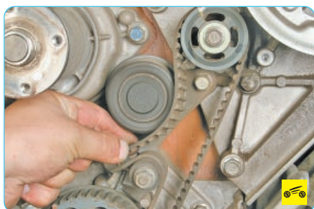
6. Сдвигая ремень с ролика натяжителя...
