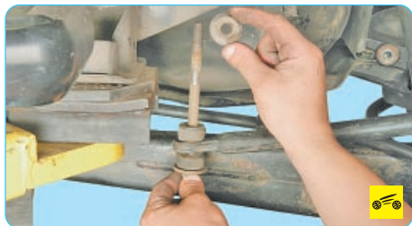
10. Снимите верхнюю опорную шайбу крепления стойки к штанге стабилизатора.
