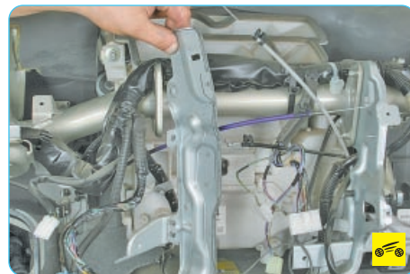
6. Снимите левый кронштейн крепления панели приборов. Аналогично снимите правый кронштейн крепления панели приборов.
