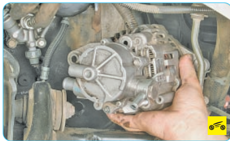
19. Снимите генератор в сборе с вакуумным насосом с автомобиля.
