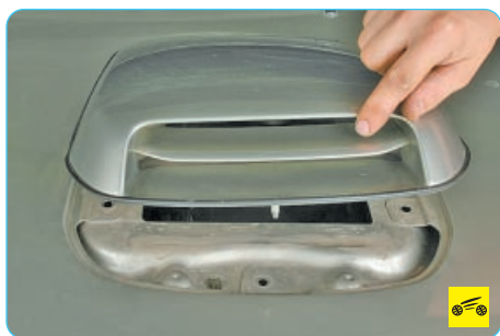
3. Снимите воздухозаборник с капота.
