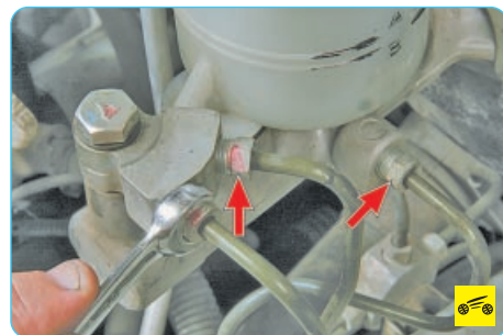
5. Отверните гайки трубок...
