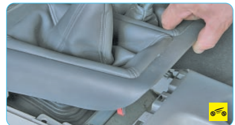
14. Аналогично снимите правую часть спинки заднего сиденья.
