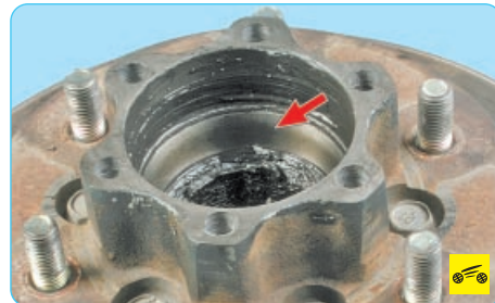
...и наружное кольца подшипника в ступице, а также рабочие поверхности роликов. Видимый износ сепаратора, роликов и колец, а также раковины и сколы на роликах не допускаются. Дефектный подшипник замените (см. «Замена подшипников ступицы переднего колеса», с. 167).
