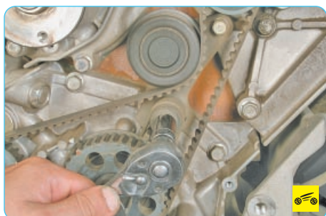
5. ...и гайку снизу.
