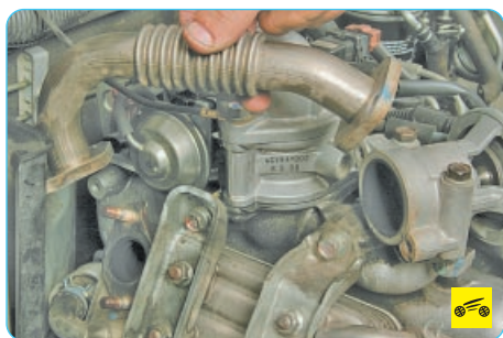
3. ...и снимите верхнюю трубку.
