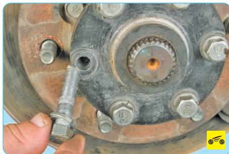
14. ...и извлеките болты крепления фланца привода переднего колеса к ступице.
