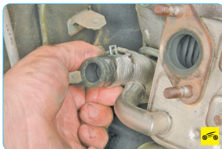
11. ...и отсоедините шланг системы охлаждения от охладителя.
