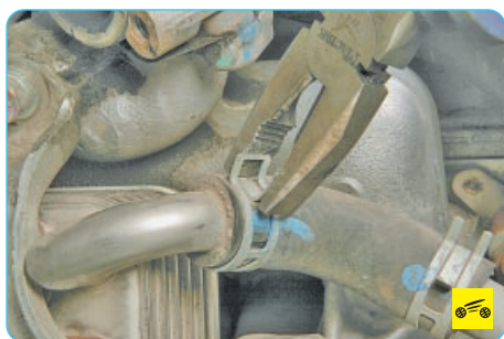
5. Сожмите хомут крепления, сдвиньте его со шланга...
