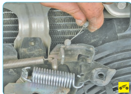
5. Отсоедините наконечник троса привода от замка капота и снимите замок.
