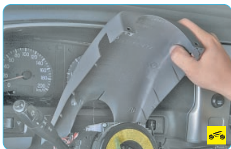
9. Для снятия контактного кольца подушки безопасности водителя снимите рулевое колесо (см. «Снятие и установка рулевого колеса», с. 180)...
