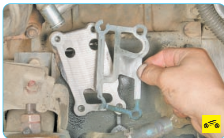
13. ...и снимите уплотнительную прокладку. При установке замените прокладку новой.
