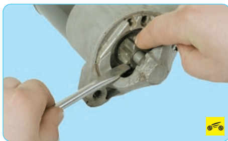
2. Проверните шестерню привода. Она должна легко проворачиваться относительно ступицы муфты в направлении вращения якоря и не должна проворачиваться в противоположном направлении.
