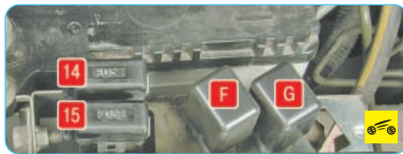
Рис. 10.2. Расположение предохранителей и реле в дополнительном монтажном блоке, установленном в моторном отсеке
