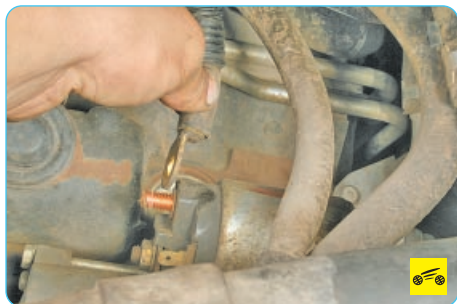
7. ...и наконечник провода дополнительной аккумуляторной батареи.
