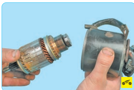
24. Извлеките из корпуса стартера ротор.
