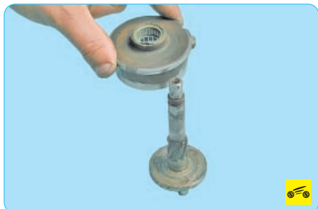
21. При необходимости замены снимите с вала привода коронную шестерню планетарного редуктора.
