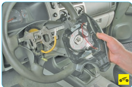
8. Снимите накладку рулевого колеса в сборе с модулем подушки безопасности водителя.
