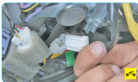
14. ...сожмите фиксатор и отсоедините колодку жгута проводов от подушки безопасности.
