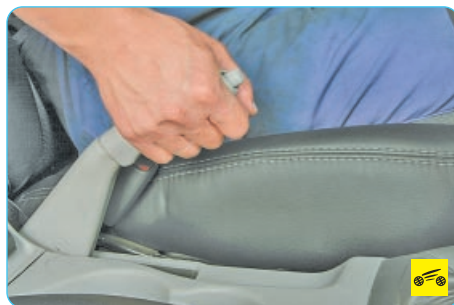
20 – рычаг стояночного тормоза.
