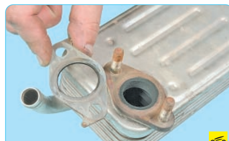
16. ...и снимите нижнюю трубку со шпилек охладителя.
