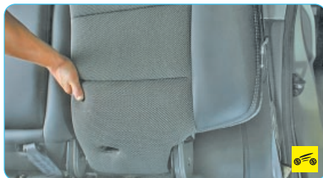
13. ...и снимите левую часть спинки сиденья.
