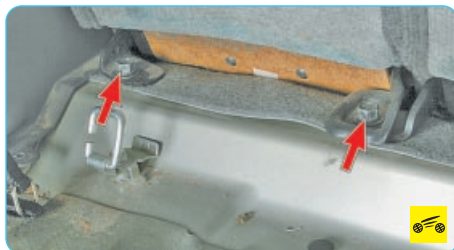
12. Выверните болты крепления левой части спинки сиденья к кузову...
