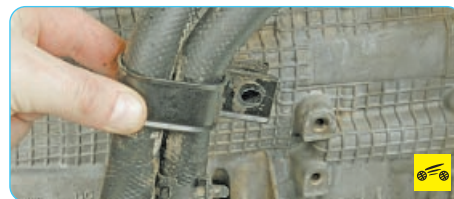
2. Выверните болт крепления...
