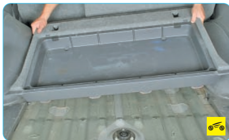
10. Снимите крышку и передний бокс для хранения инструментов.
