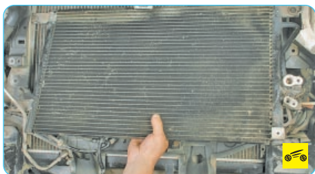
15. ...и снимите конденсор.
