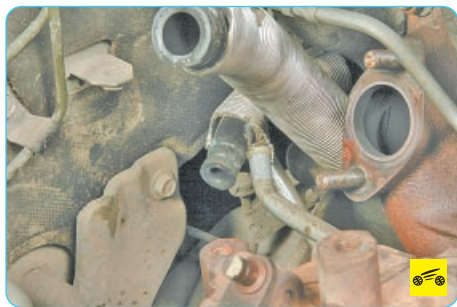
17. ...и отсоедините шланг отвода охлаждающей жидкости от турбокомпрессора.
