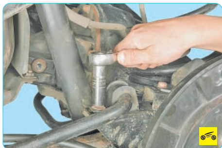
14. Замените изношенные детали стоек стабилизатора поперечной устойчивости.
