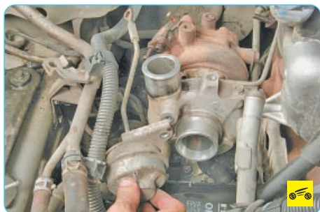
25. ...и снимите пневмопривод системы изменения геометрии турбины.
