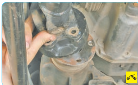
65. Снимите переднюю карданную передачу (см. «Снятие и установка передней карданной передачи», с. 141).
