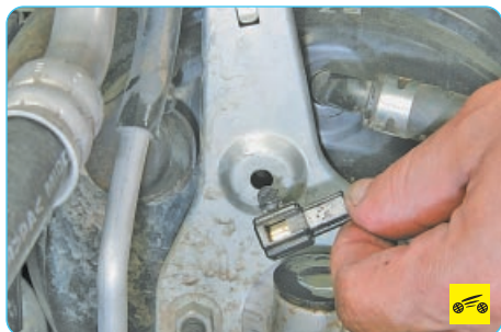
9. ...и отсоедините колодку датчика от кронштейна.
