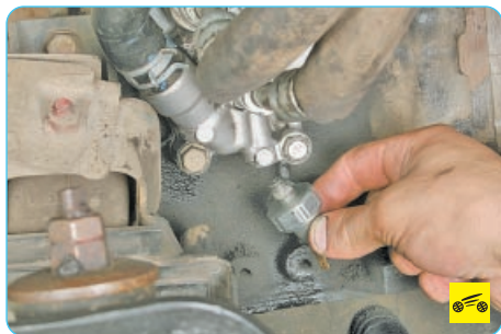
6. ...и снимите датчик с кронштейна масляного фильтра.
