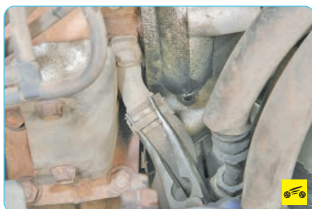
15. Отожмите плоскогубцами хомут и отсоедините шланг системы смазки от турбокомпрессора снизу.
