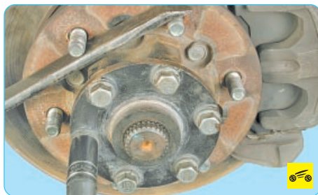
13. Удерживая ступицу монтажной лопаткой, выверните...
