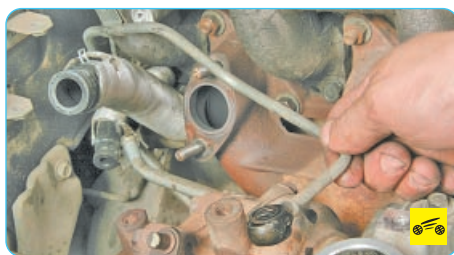
13. ...отсоедините и отведите в сторону трубопровод системы смазки турбокомпрессора.
