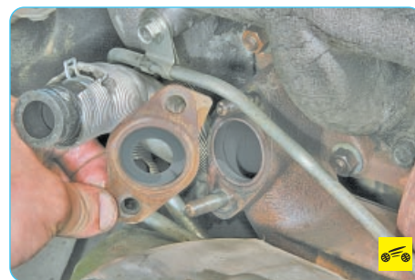
14. Снимите уплотнительную прокладку со шпилек выпускного коллектора.
