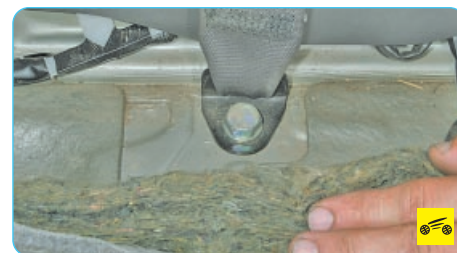
2. Отведите в сторону шумоизоляционный настил пола для доступа к нижнему креплению переднего ремня безопасности.
