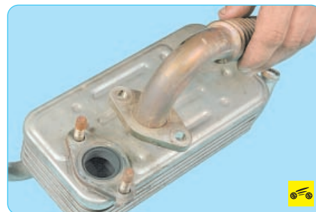
16. ...и снимите нижнюю трубку со шпилек охладителя.
