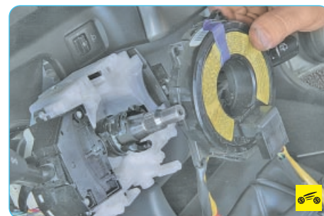
16. Снимите контактное кольцо.
