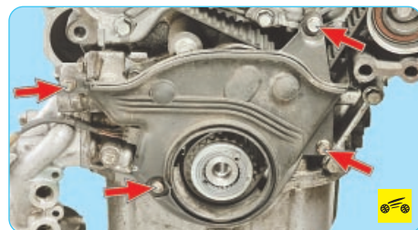
14. Выверните четыре болта крепления нижней крышки газораспределительного механизма...
