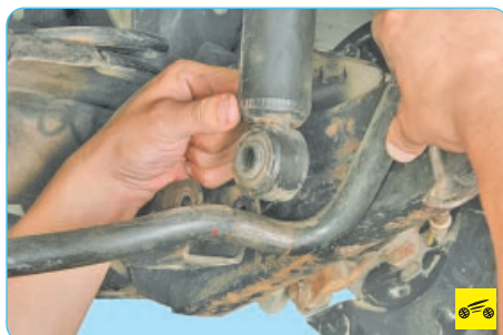
19. Отсоедините амортизаторы задней подвески от кронштейнов на заднем мосту.
