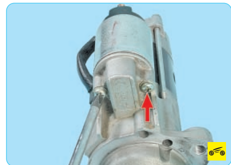
3. Выверните два винта крепления тягового реле к крышке стартера со стороны привода...
