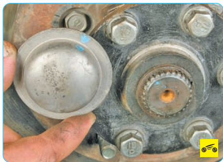
8. ...и снимите крышку ступицы переднего колеса.
