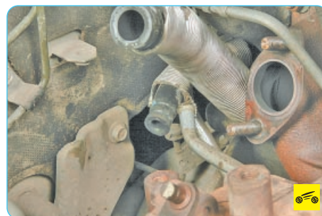
19. ...и отсоедините от турбокомпрессора шланг отвода охлаждающей жидкости.
