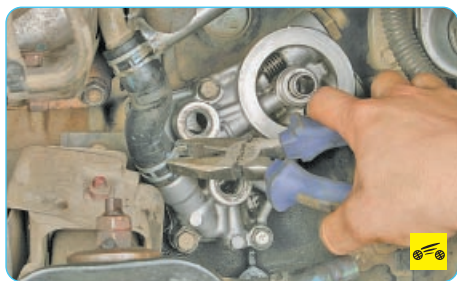
9. Ослабьте хомут крепления шланга системы смазки турбокомпрессора и сдвиньте его вверх по шлангу.
