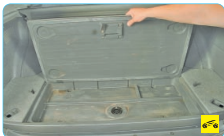
8. Снимите крышку заднего бокса для хранения инструментов...
