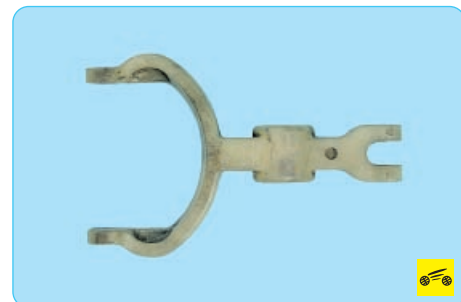
31. На рычаге привода стартера не должно быть трещин и следов значительного износа пазов вилок.
