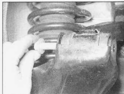
3.4. Wykręcanie śruby mocującej wysięgnik do wahacza górnego zawieszenia przedniego
