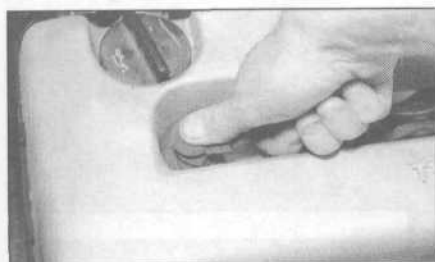
A Sprawdzanie za pomocą nacisku palcem prawidłowości osadzenia końcówek przewodów wysokiego napięcia na świecach zapłonowych...
