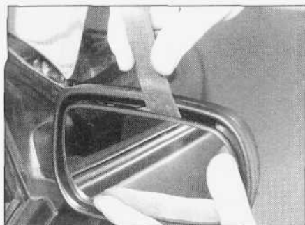
22.9a. Wsuwanie odpowiedniej dźwigni za szkło lusterka...
