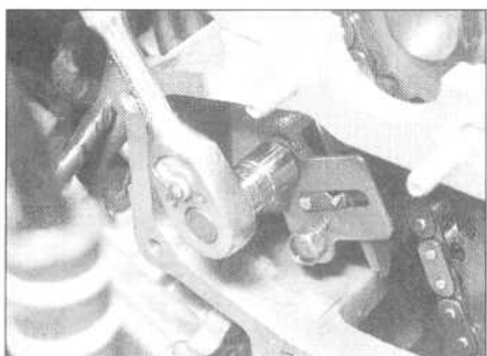
7.29a. We wcześniejszych modelach należy wstawić napinacz przy cofniętym trzpieniu, następnie dokręcić śruby...
