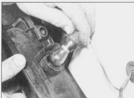
5.66. Wyjmowanie żarówki tylnej lampy zespolonej - modele kombi
