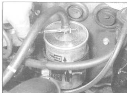
13.2. Zwolnić mocujące zaciski i odłączyć elastyczny przewód od filtra...
