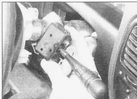
4.3. Wysuwanie przełącznika wycieraczek i spryskiwaczy ze wspornika kolumny kierownicy
