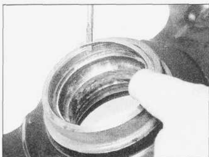
2.14a. Wyjmowanie zewnętrznego pierścienia osadczego ze zwrotnicy
