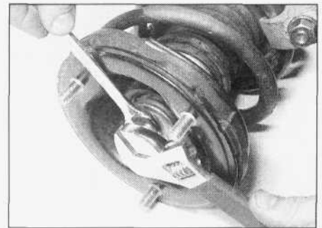
3.10. Odkręcanie nakrętki trzpienia amortyzatora
