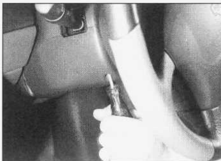
28.2a. Wykręcanie jednego z sześciu wkrętów mocujących osłonę kolumny kierownicy...
