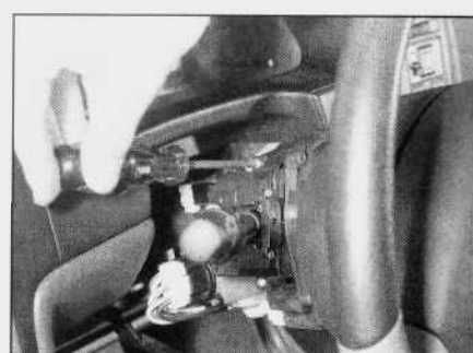
4.3. Wykręcanie wkrętów mocujących odpowiedni przełącznik na kolumnie kierownicy
