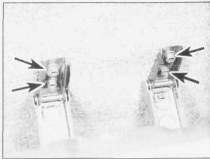
26.11. Śruby mocujące siedzisko siedzenia tylnego (strzałki)
