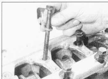
18.34b. ... a następnie (w silniku 2,0) zakładanie wspornika pokryw łożysk głównych i wkładanie śruby mocującej z podkładką
