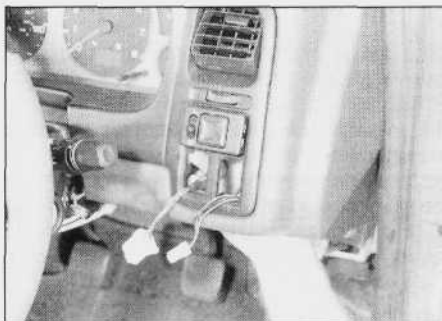
4.16. Wyłącznik elektrycznej regulacji lusterka z należy wypchnąć od tyłu osłony tablicy rozdzielczej
