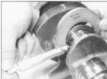
14.11 b. Pomiar średnicy czopa łożyska korbowego za pomocą mikrometru
