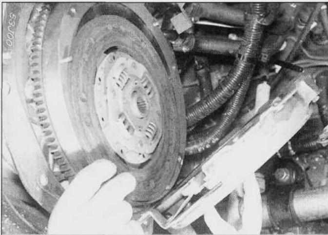
5.14. Montowanie tarczy (zespół sprężyn piasty powinien znajdować się po stronie przeciwnej do koła zamachowego) i zakładanie zespołu dociskowego
