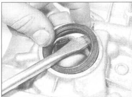
6.14a. Podważanie wkrętakiem pierścienia uszczelniającego wał korbowy...
