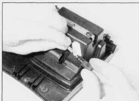
6.32. Wymontowanie wciśniętej żarówki oświetlenia zapalniczki
