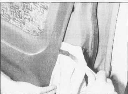
12.7a. Zwalnianie zacisków zabezpieczających osłonę pokrycia wewnętrznego drzwi...
