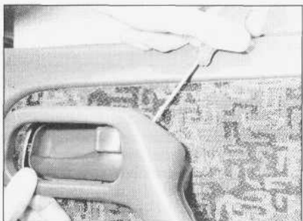
12.5a. Podważanie wkrętakiem górnej części osłony klamki wewnętrznej...
