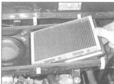
27.3b. Wyjmowanie wkładu filtra powietrza - silnik 1,6 o wtrysku paliwa
