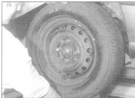
20.4. Kołysanie kołem jezdny w celu sprawdzenia elementów układu kierowniczego i zawieszenia
