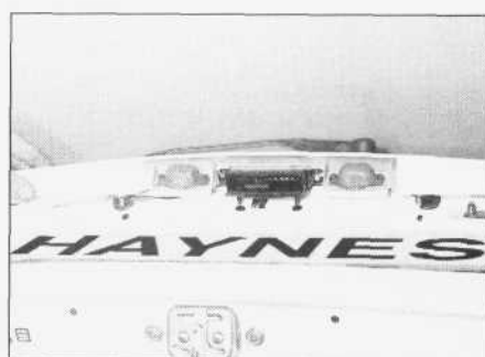
18.23. Osłona wykładziny zewnętrznej z klamką z drzwi tyłu nadwozia - modele kombi
