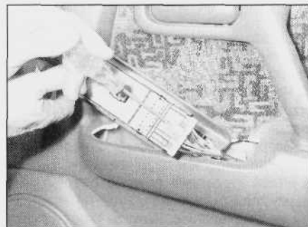
4.22b. ... i odłączanie przewodów elektrycznych
