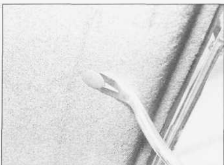
28.51. ... i górnego zacisku zabezpieczającego z osłony wewnętrznej drzwi tyłu nadwozia - modele kombi
