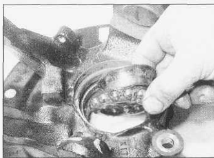
2.14b. Wyjmowanie wewnętrznego pierścienia łożyska z piasty
