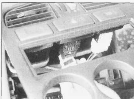
28.11. Odłączanie złącza przewodów elektrycznych z tyłu osłony...
