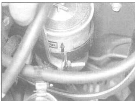
13.3. ...a następnie poluzować śrubę zacisku i wysunąć filtr
