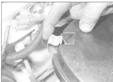
27.1 b. Zwalnianie zatrzasków mocujących pokrywę filtra powietrza
