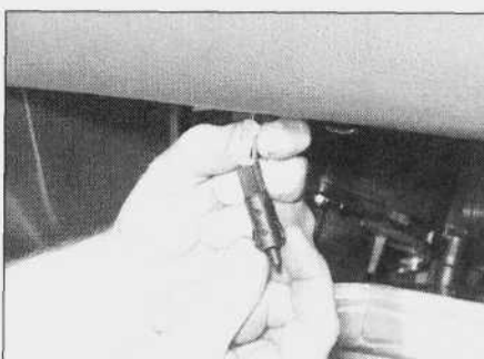
4.36. Wyjmowanie wyłącznika oświetlenia schowka podręcznego
