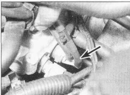
2.22. W wersjach gaźnikowych zawór TVV (strzałka) jest wkręcony w prawy koniec kolektora dolotowego
