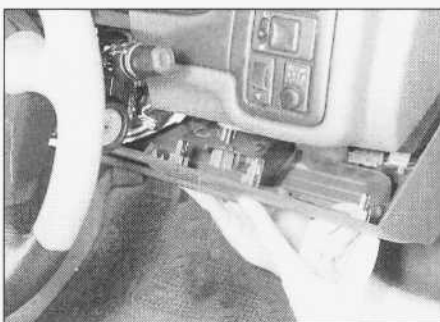
28.7a. Odciąganie w dół dolnej osłony tablicy rozdzielczej, po stronie kierowcy, w celu zwolnienia zacisków...
