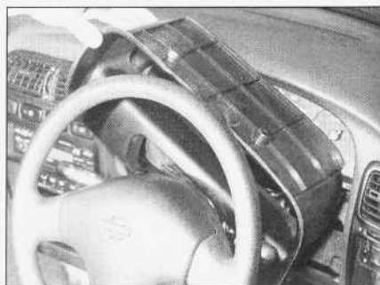
30.31. ... wyjmowanie osłony tablicy rozdzielczej
