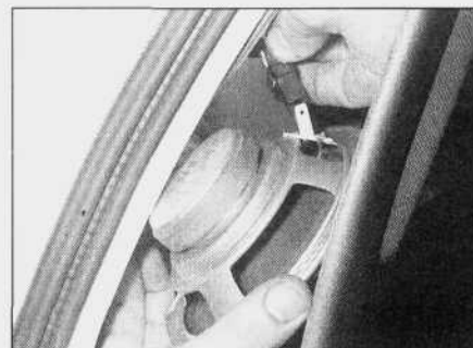
20.23b. ... wyjmowanie głośnika tylnego i odłączanie wtyku przewodów elektrycznych - modele kombi
