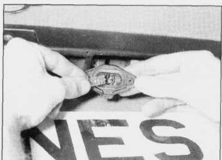
5.38. Żarówka lampy oświetlenia tablicy rejestracyjnej jest wciśnięta w gniazdo
