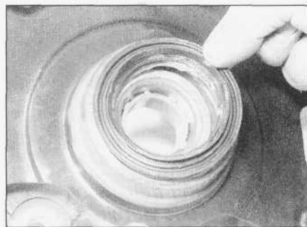
2.19. Zamontowanie zewnętrznego pierścienia uszczelniającego
