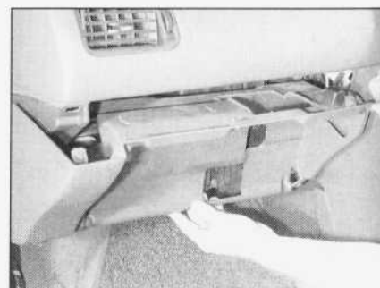
28.25a. Wyjmowanie schowka z tablicy rozdzielczej...
