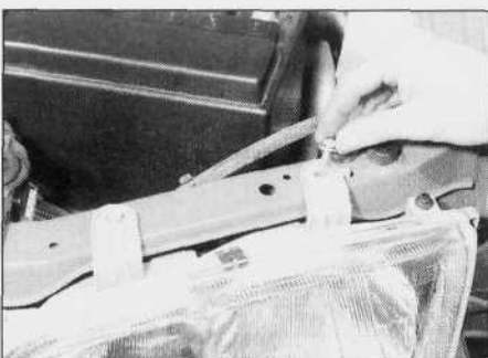
7.3. Wykręcanie górnej śruby mocującej zespół światła reflektora...
