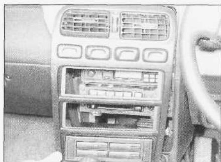
30.15c. ... odłączanie od tablicy rozdzielczej środkowej osłony z wyłącznikami i dyszami nawiewu
