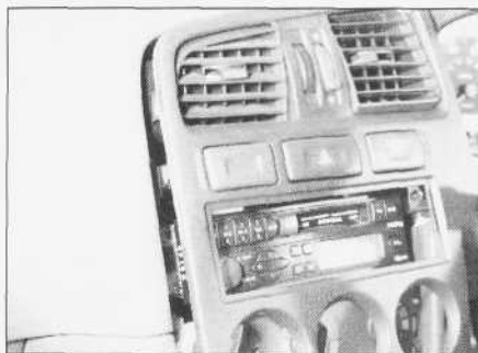
28.1 Oc. ... następnie odsuwanie osłony od tablicy rozdzielczej w celu zwolnienia zacisków
