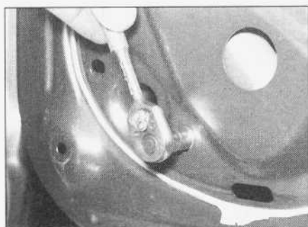
14.14a. Odkręcanie dolnej śruby mocującej...
