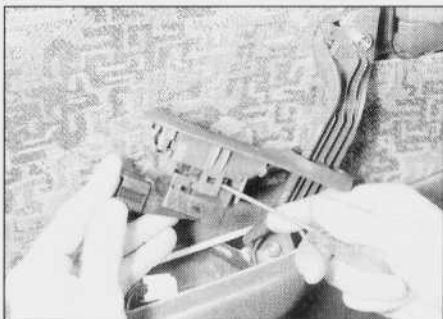
4.27. ... i wymontowanie wyłącznika po zwolnieniu zaczepów plastikowych
