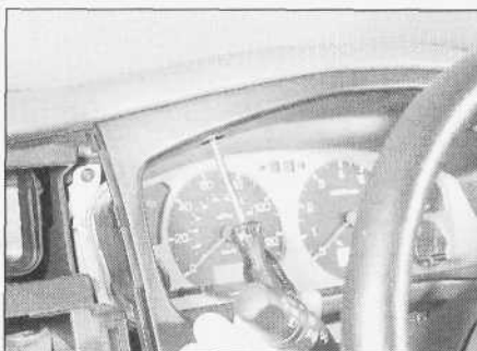
28.16a. Wykręcanie jednego z dwóch górnych wkrętów mocowania ramki zespołu wskaźników...
