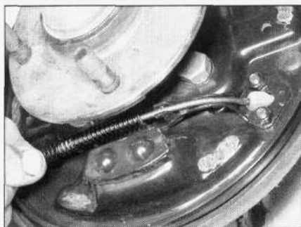
6.10. Przesuwanie sprężyny ściągniętej szczęki po linie hamulcowej
