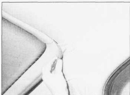
26.29a. Wyjmowanie zaślepki wkrętu z górnego narożnika osłony...
