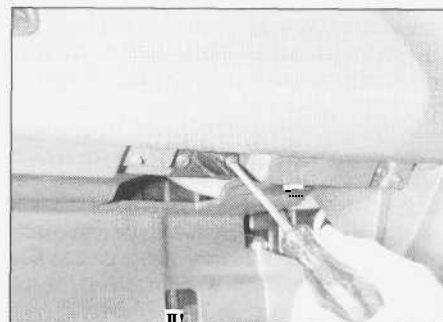
28.22. Wykręcanie jednego z dwóch wkrętów środkowych w celu wymontowania zatrzasku schowka
