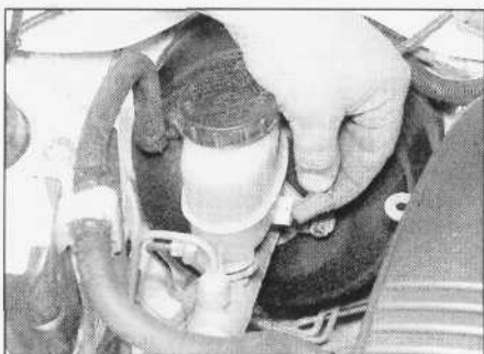
12.1. Odłączanie złącza przewodów elektrycznych od czujnika poziomu płynu hamulcowego
