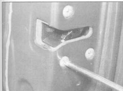
13.33a. Wykręcanie trzech śrub mocowania zamka
