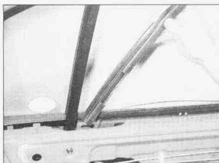
14.15. Odciąganie uszczelki z górnego tylnego narożnika otworu okna
