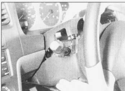
28.2b. ... następnie wyjmowanie górnej i dolnej osłony kolumny kierownicy
