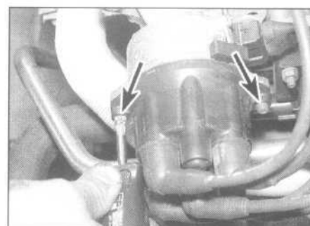
28.9a. Wkręty (strzałki) mocujące kopułkę rozdzielacza
