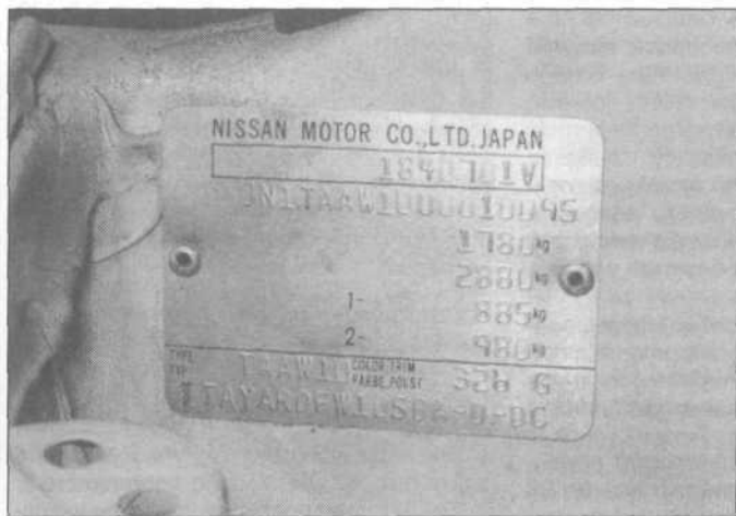
Widok tabliczki znamionowej zawierającej numer identyfikacyjny pojazdu (VIN) przynitowanej do przegrody czołowej nadwozia w przedziale silnika....
