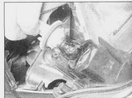
5.27. Wyjmowanie gniazda żarówki z zespołu kierunkowskazu przedniego - modele sedan i hatchback
