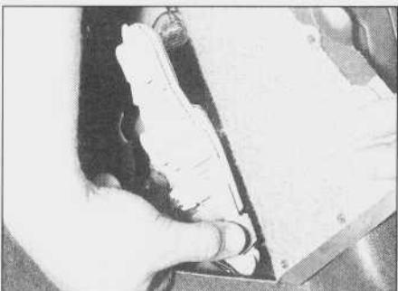
5.60. Wyjmowanie gniazda tylnego światła zespolonego - modele hatchback
