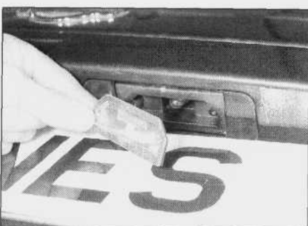
5.40b.... i wyjmowanie klosza lampy tablicy rejestracyjnej - modele kombi
