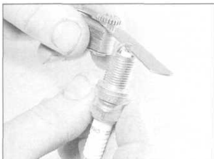
5.9a. Pomiar odstępu elektrod świecy zapłonowej za pomocą szczelinomierza
