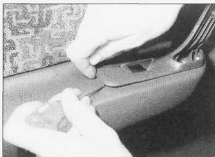
12.14. Podważanie wkrętakiem osłony wyłącznika elektrycznego sterowania szyby...
