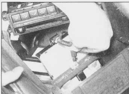
6.35. Wyjmowanie gniazda żarówki oświetlenia popielniczki
