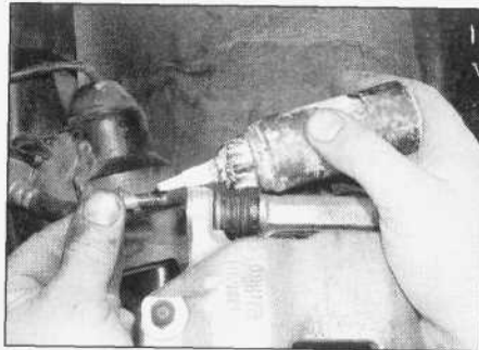
4.13b. Nakładanie specjalnego środka na gwinty śrub prowadnika zacisku Girling
