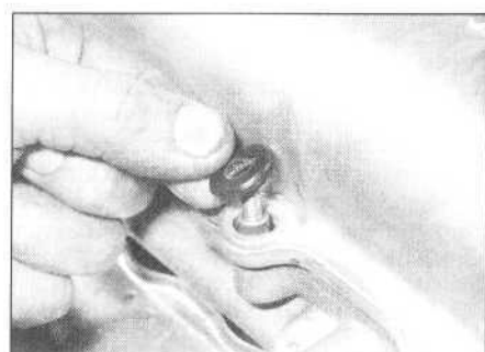
4.11 a. Zakładanie gumowej uszczelki na każdą śrubę dwustronną...
