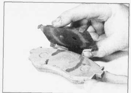
4.22. Wkładka cierna i podkładka - zacisk Bendix
