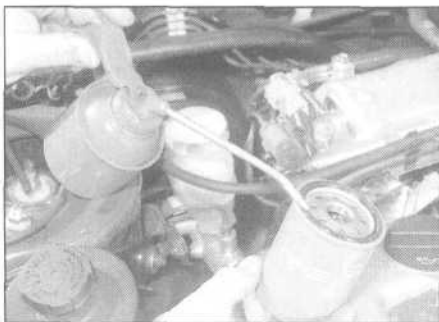
3.11 a. Przed zamontowaniem nowego filtra oleju należy go pierścieniem uszczelniającym powlec czystym olejem silnikowym
