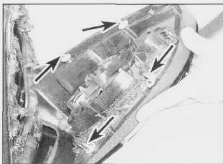
7.30. Wymontowanie obudowy tylnego światła - modele hatchback (strzałki pokazują dwustronne śruby mocujące)
