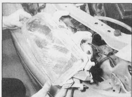
7.5b. ... i wymontowanie zespołu światła reflektora
