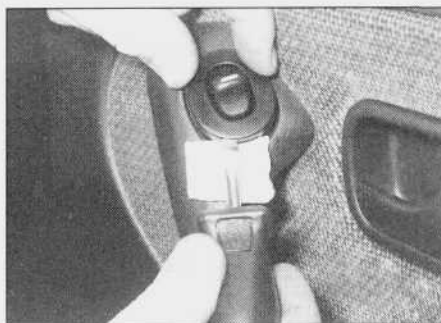
4.21. Wyjmowanie przełącznika elektrycznego sterowania szyby z drzwi przednich
