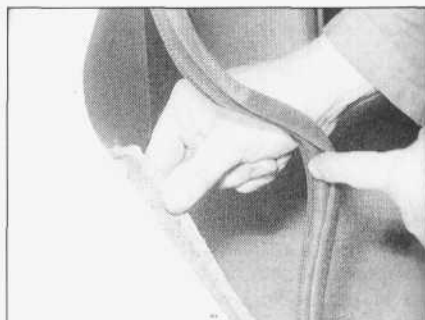
27.26. Wysuwanie uszczelki z tylnego narożnika otworu drzwi - modele kombi
