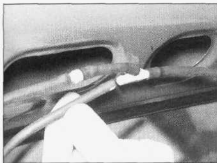
8.2. Odłączanie elastycznego przewodu spryskiwacza od złącza na pokrywie przedziału silnika
