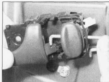
13.4b. ... i odłączanie cięgieł roboczych zamka od klamki wewnętrznej
