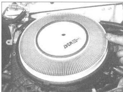
27.3a. Wyjmowanie wkładu filtra powietrza - silnik 1,6 gaźnikowy
