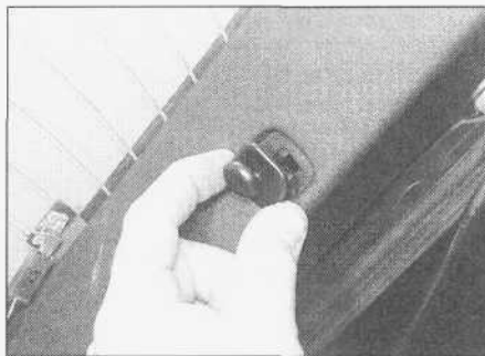
28.46b. ... wyjmowanie zaczepów linek odciągających półkę tylną...
