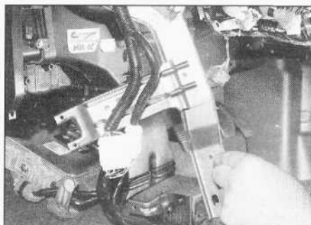
9.24c. ... i wyciąganie z lewej strony metalowego wspornika
