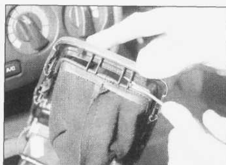
27.4a. Zwalnianie osłony dźwigni zmiany biegów z zacisków na obwodzie...
