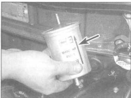
13.5. Przy ponownym montowaniu filtra należy zwrócić uwagę, aby strzałka na obudowie filtra (strzałka) była zwrócona w kierunku przepływu paliwa
