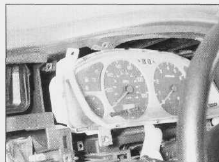
9.4. Wymontowanie osłony zestawu wskaźników i rozłączanie złącza elektrycznego
