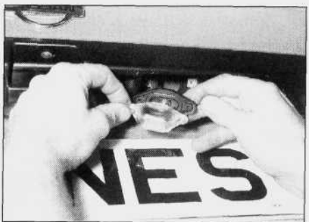
5.37. Wyjmowanie klosza lampy oświetlenia tablicy rejestracyjnej i gniazda żarówki po wykręceniu wkrętów - modele sedan i hatchback
