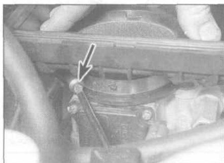
2.4a. ...a następnie zdejmowanie zacisków mocujących obudowę filtru powietrza do obudowy przepustnicy
