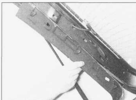
28.46c. ... i odłączanie osłony wykładziny od drzwi tyłu nadwozia - modele hatchback
