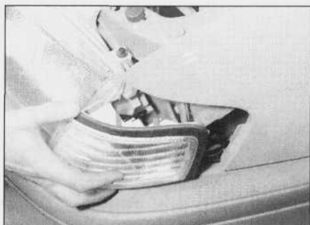
7.9. Odłączanie kierunkowskazu od światła reflektora i błotnika przedniego
