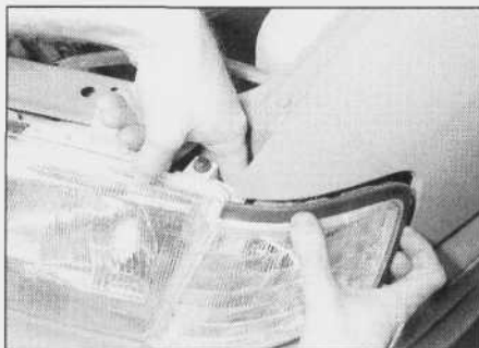
7.8. Naciskanie plastikowego występu mocującego kierunkowskaz do zespołu światła reflektora
