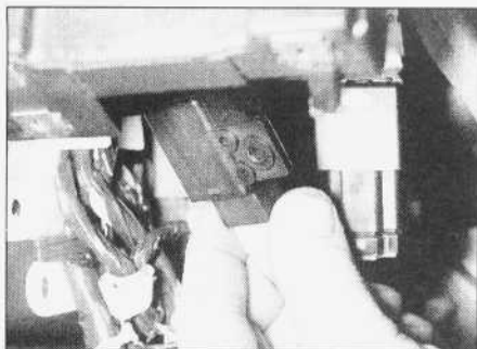
30.40. Odłączanie elementu ostrzegającego, że pozostały włączone światła, od tyłu tablicy rozdzielczej
