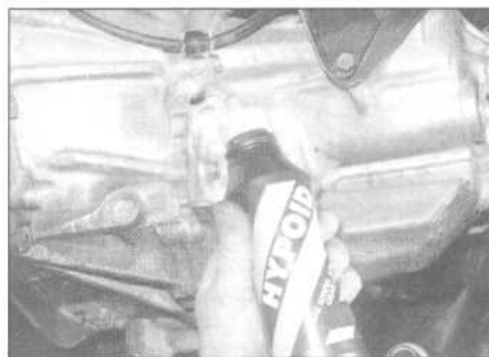
7.3. Dolewanie oleju do mechanicznej skrzynki przekładniowej
