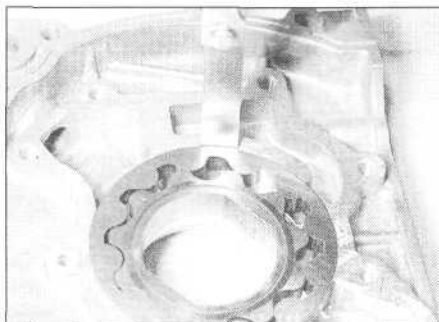
13.6a. Pomiar luzu pomiędzy zewnętrznym wirnikiem a obudową
