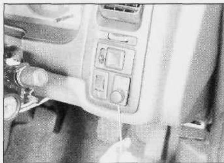
4.14. Wyjmowanie wyłącznika regulacji ustawienia świateł reflektorów za pomocą małego wkrętaka
