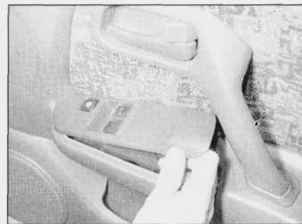
4.22a. Unoszenie osłony z wyłącznikami, znajdującej się w drzwiach kierowcy...
