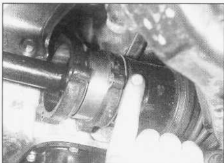
2.14. Odłączanie obudowy łożyska od wspornika - wersje z silnikiem 2,0
