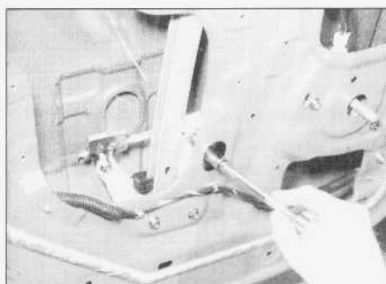
14.16a. Wykręcanie dwóch śrub mocujących dolną krawędź szyby do podnośnika szyby...
