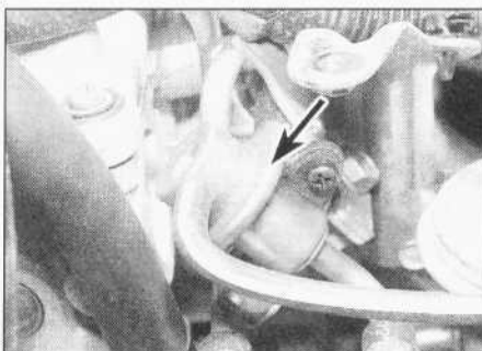
13.10. Regulator ciśnienia paliwa (strzałka) zamontowany na lewym końcu kolektora paliwa
