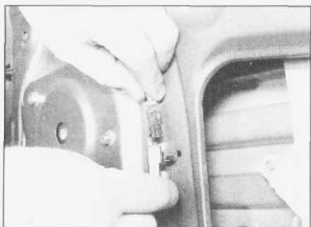
14.33. Rozłączanie części złącza przewodów elektrycznych silnika podnośnika - modele sedan i hatchback
