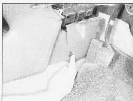
28.31a. Wykręcanie zacisku zabezpieczającego osłonę we wnętrzu na nogi, po stronie kierowcy
