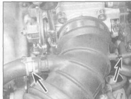
2.10a. Elastyczne przewody (strzałki), które należy odłączyć i zaciski mocujące przewód dolotowy (wersje z silnikiem 2,0)...
