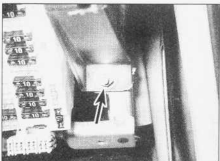
30.45. Dolna prawa nakrętka górnej osłony tablicy rozdzielczej (strzałka)
