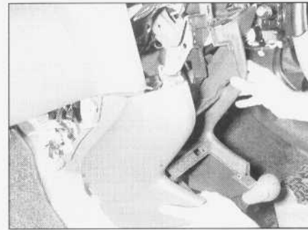
28.34b. ... i wymontowywanie dolnej środkowej osłony
