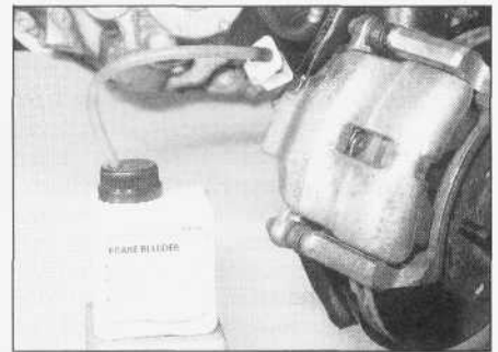
2.22. Zestaw odpowietrzający z zaworem jednokierunkowym podłączony do zacisku hamulca przedniego
