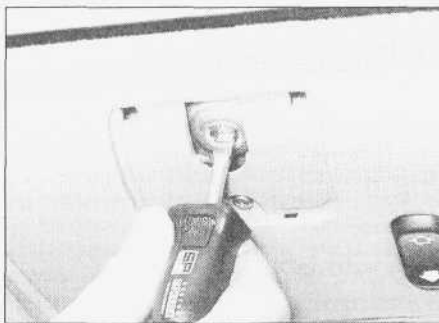
24.2. Ręczne zamykanie dachu (za pomocą wkrętaka)
