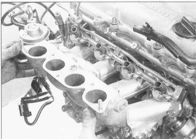
15.32a. Wymontowanie dolnej części kolektora dolotowego...
