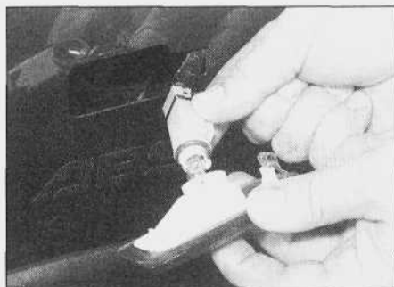
5.36. Wyjmowanie gniazda żarówki kierunkowskazu bocznego
