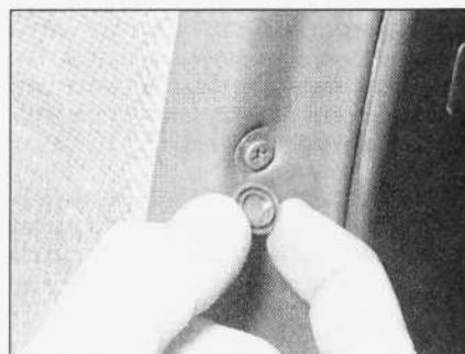
12.5. Wyjmowanie zaślepki w celu uzyskania dostępu do tylnego wkrętu mocowania pokrycia drzwi
