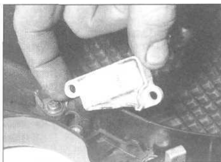
29.3b. ... i wymontowywanie zespołu filtra PCV z pokryw filtra powietrza
