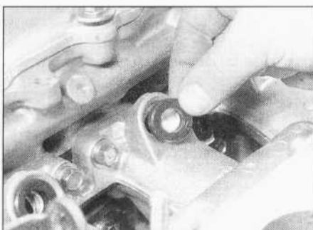
14.9b. ... zakładanie nowych pierścieni uszczelniających na wtryskiwacze paliwa
