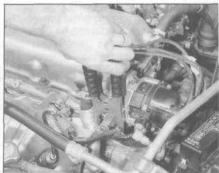
4 Połączyć drugi koniec czarnego przewodu rozruchowego ze śrubą lub wspornikiem na kadłubie silnika, dość daleko od akumulatora samochodu, który ma być uruchomiony
