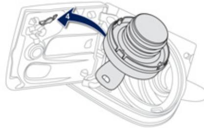
Отверните крышку горловины вместе с ключом. Закончив заправку, заверните крышку до конца, поворачивая ее вправо, пока не услышите два щелчка, и закройте лючок. Емкость топливного бака: около **35** литров.
