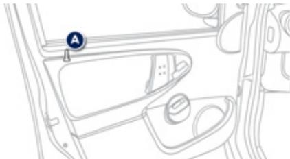
Для блокировки/разблокировки дверного замка нажмите или поднимите кнопку **A**.
