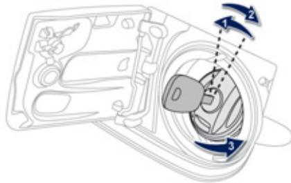
Откройте лючок, вставьте ключ в крышку горловины и слегка поверните его сначала влево, а затем вправо. Ключ возвращается в исходное положение и крышку можно снять с горловины бака.
