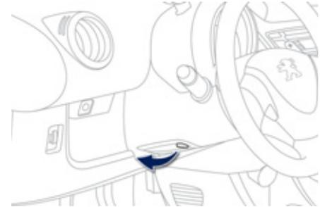
**На остановленном автомобиле** опустите рычаг, чтобы разблокировать механизм регулировки рулевого колеса. Отрегулируйте положение рулевого колеса по высоте и поднимите рычаг, чтобы зафиксировать регулировку.
