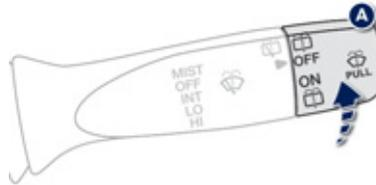
Поверните кольцевой выключатель **A** в положение **"ON"**, чтобы включить стеклоочиститель.
