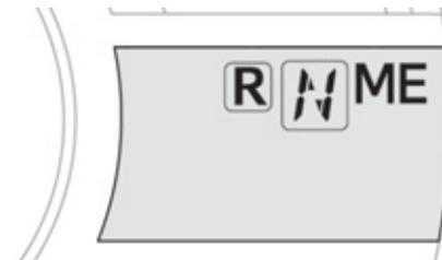
Положение рычага селектора (**R**, **N**, **E** или **M**) и включенная передача (с 1 по 5) отображаются на дисплее панели приборов.
