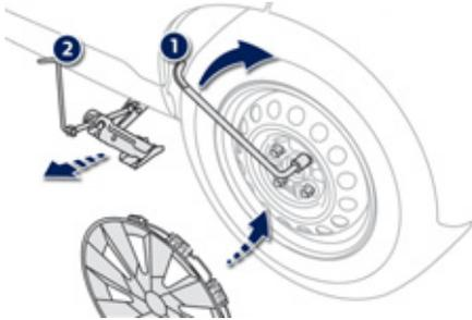
5. Затяните до упора болты крепления колеса баллонным ключом 1.
