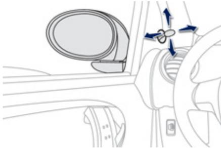
Перемещая рычажок в четырех направлениях, отрегулируйте положение зеркала.
