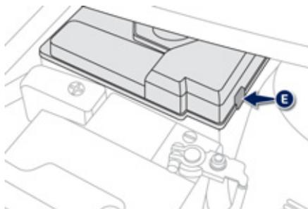
☞ Снимите с крышки фиксатор, нажав вправо на выступ **Е**, чтобы получить доступ к предохранителям.
