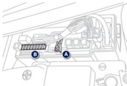
Пинцет **А** и запасные предохранители **В** расположены в передней части блока.
