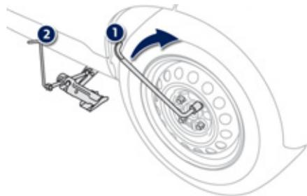
3. Предварительно затяните болты\* при помощи баллонного ключа 1.
