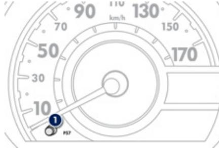
Для установки счетчика пробега за поездку на ноль, включите его индикацию и длительно нажмите на кнопку 1.
