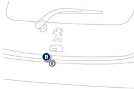
Чтобы открыть багажник, поверните ключ в замке **В** и поднимите крышку.
