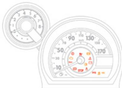
При включении зажигания загораются контрольные лампы оранжевого и красного цвета. Как только двигатель начнет работать, они должны погаснуть. Если какие-либо из них продолжают гореть, см. информацию в соответствующей рубрике.
