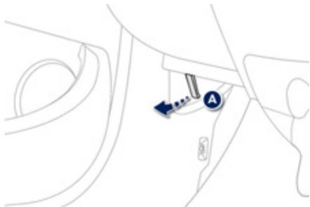
**Из салона автомобиля:** потяните за ручку **A**, расположенную под панелью приборов.
