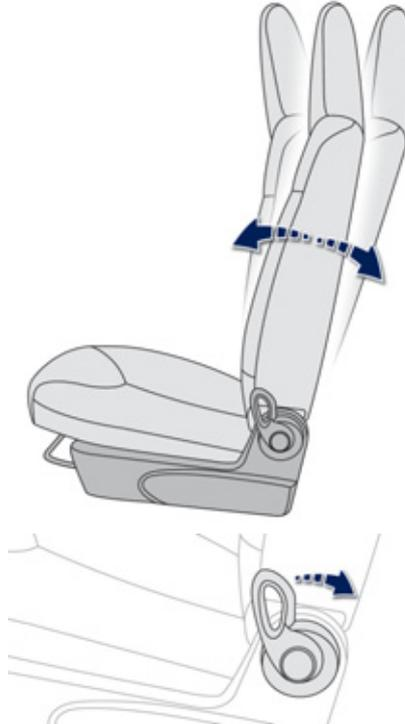
2. Регулировка наклона спинки.
