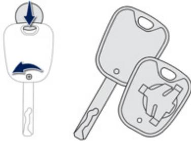
Отверните винт и раскройте корпус пульта при помощи монеты, вставив ее возле кольца.
