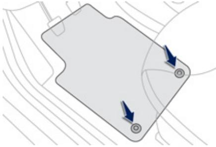
Чтобы убрать коврик, находящийся перед сиденьем водителя, сдвиньте сиденье максимально назад и уберите фиксаторы. При установке на место расположите его правильно и установите на фиксаторы. Убедитесь, что коврик закреплен прочно.
