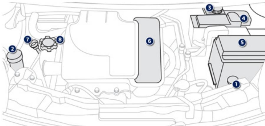
1. Расширительный бачок с охлаждающей жидкостью
