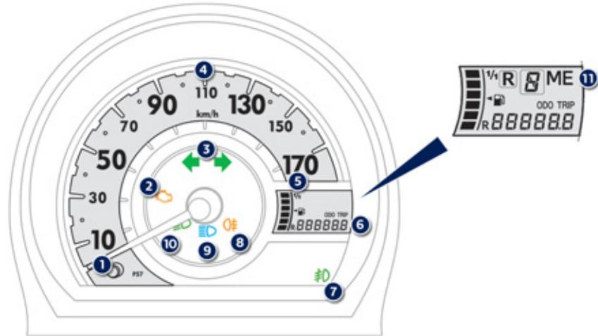
1. Кнопка переключения счетчиков общего пробега и пробега за поездку, кнопка установки на ноль счетчика пробега за поездку
