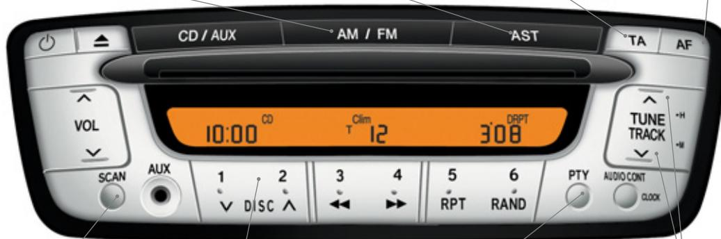
Автоматический поиск в верхнем частотном диапазоне: нажать дважды / Последовательное прослушивание станций.
