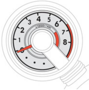
Достигнув максимальных оборотов, когда стрелка тахометра заходит в красную зону, Вы должны перейти на более высокую передачу.
