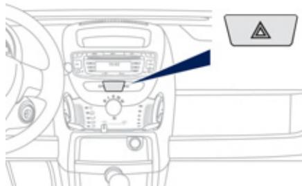
Нажмите на выключатель. При этом все фонари указателей поворотов начнут мигать. Аварийная световая сигнализация может работать и при выключенном зажигании.
