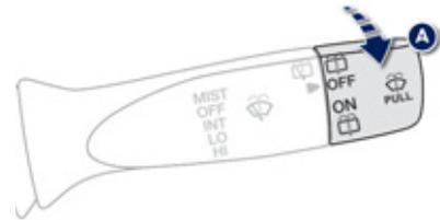
Кольцевой выключатель **A** в положении **"OFF"** ("стеклоочиститель выключен").
