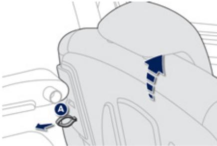
Спинку следует складывать со стороны открытого багажного отсека:
