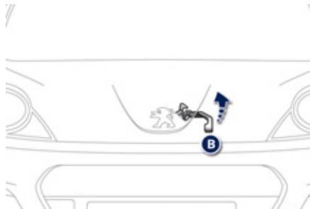
**Снаружи:** отожмите крючок **B** и поднимите капот.
