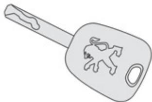
Ключами можно отпирать и запирают замки передних дверей, багажника, крышки горловины топливного бака, разблокировать рулевую колонку, включать и отключать подушку безопасности переднего пассажира, а также включать зажигание.
