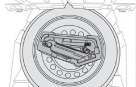
В нише под ковриком и пластмассовой крышкой уложены инструменты для замены колеса и буксировки автомобиля.
