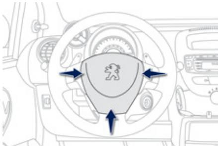
Система звукового оповещения предназначена для уведомления других участников дорожного движения об угрожающей опасности.
