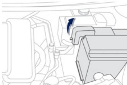
Аккумуляторная батарея расположена под капотом.
