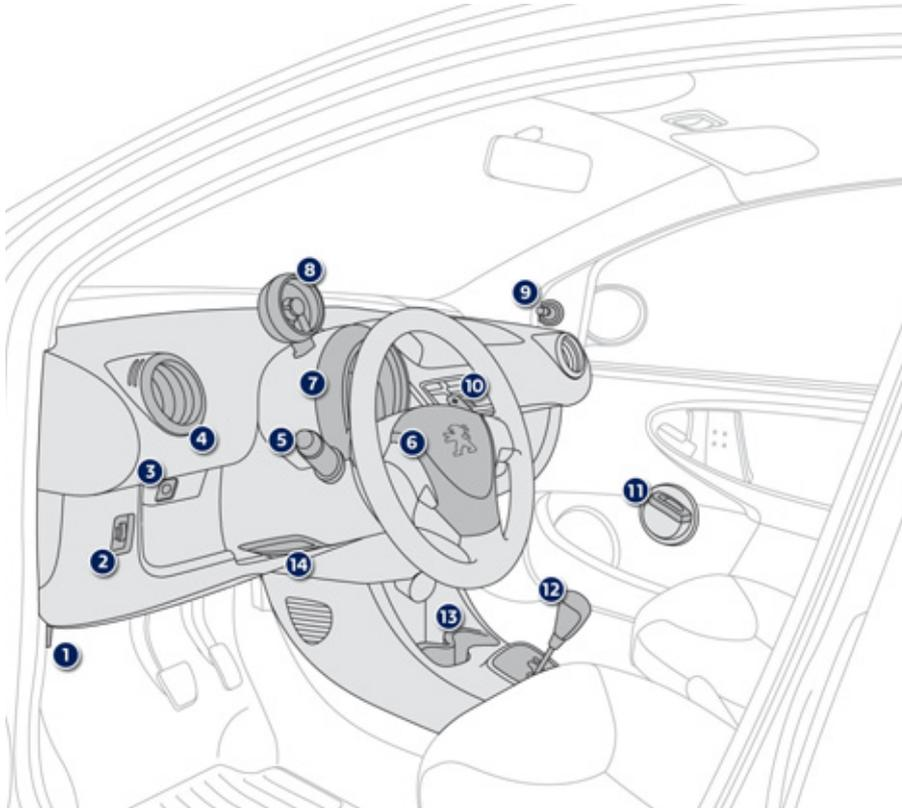
1. Рукоятка привода замка капота
