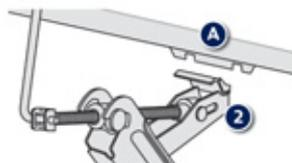
3. Установите домкрат 2 под одно из специально предназначенных для этого четырех опорных гнезд А в нижней части кузова, расположенное ближе всех к снимаемому колесу.
