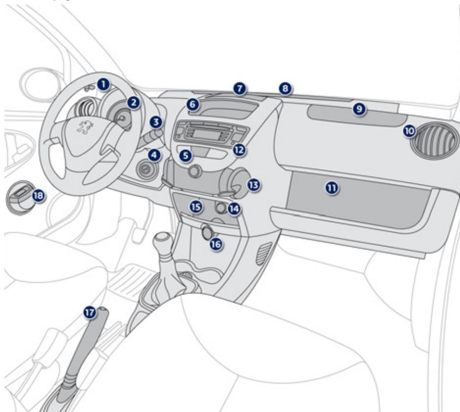
1. Привод настройки левого наружного зеркала заднего вида
