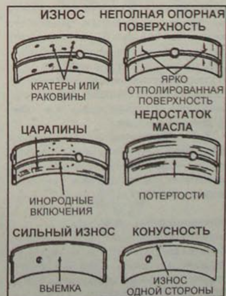
Рис. 2.54. Типичные дефекты подшипников
