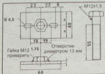
Рис. 1.63. Размеры приспособления для снятия шкива привода зубчатого ремня с коленчатого вала
