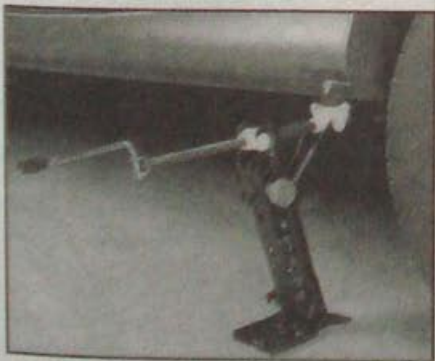
Установка домкрата под площадку, расположенную около заменяемого колеса
