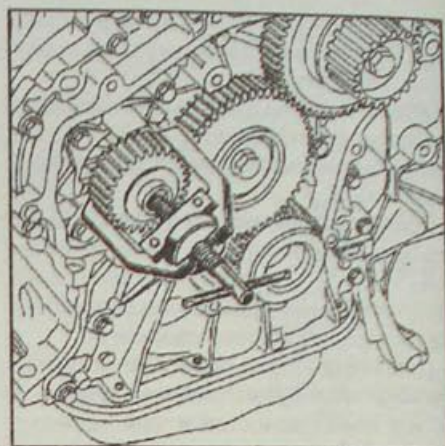
Рис. 4.72. Использование съёмника U 14 L FACOM для снятия шестерни с водяного насоса
