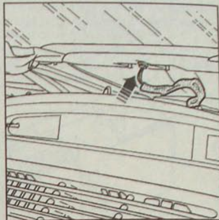
Рис. 14.17. Выталкивание датчика интенсивности солнечного излучения из панели приборов
