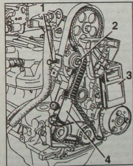
Рис. 1.23. Натяжение ремня привода газораспределительного механизма: 1 – болт М6х45; 2 – гайка крепления натяжного ролика; 3 – прибор для проверки натяжения ремня Tronic 105.6; 4 – датчик проверки натяжения
