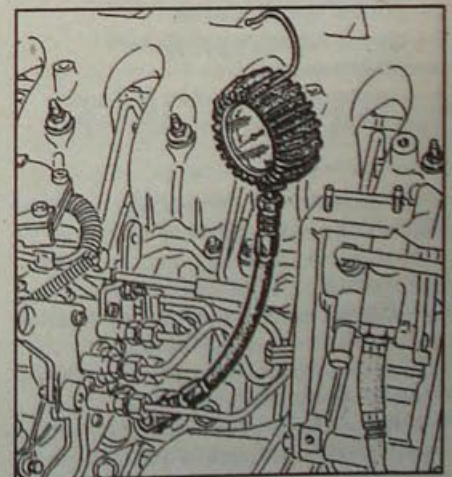
Рис. 3.71. Использование манометра с переходником для проверки давления моторного масла
