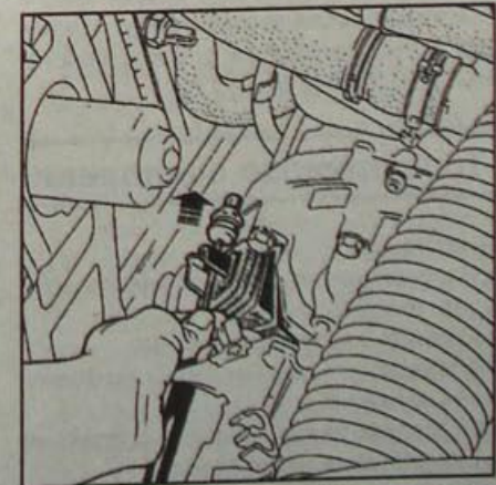
Рис. 5.8. Проверка свободного хода троса привода сцепления на автомобилях с бензиновыми двигателями
