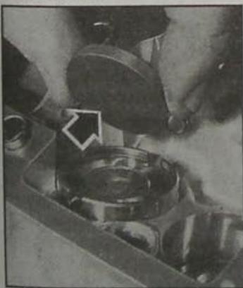
Рис. 1.4. Установка регулировочной шайбы маркировкой к толкателю
