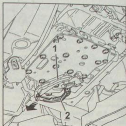
Рис. 7.10. Снятие рычага переключателя режимов:
