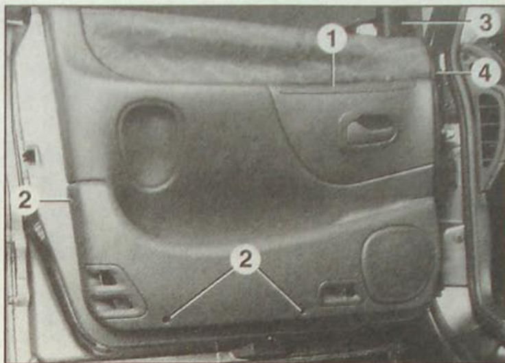
Рис. 13.11. Снятие обивки передней двери:
