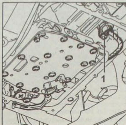
Рис. 7.9. Расположение болта (1) крепления герметичного разъема
