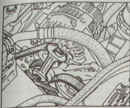
Рис. 1.90. Отворачивание болта крепления натяжного ролика ремня привода водяного насоса на автомобилях с системой кондиционирования воздуха
