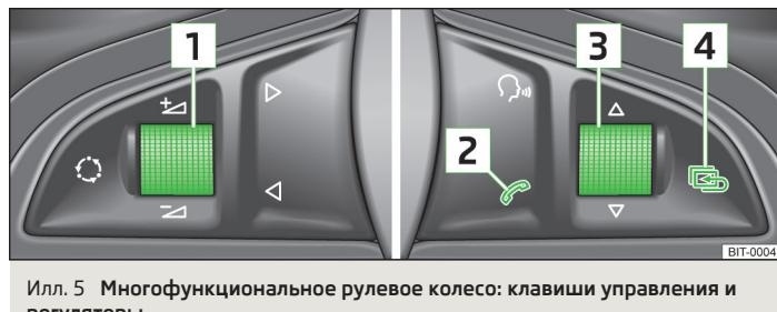
Илл. 5 Многофункциональное рулевое колесо: клавиши управления и регуляторы
