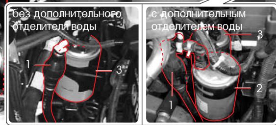
1. Насос для подкачки 2. Водоотделитель 3. Топливный фильтр
