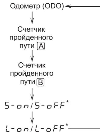
\* Когда замок зажигания находится в положении “ON”, надписи “5-on” или “5-off” и “L-on” или “L-off” не отображаются.
