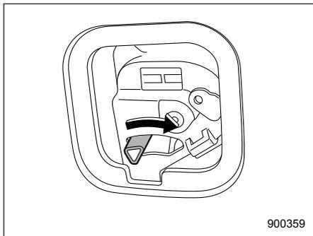
3. Отоприте дверцу багажного отсека, переведя рычажок вправо при помощи плоской отвертки или другого подобного инструмента.
