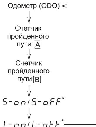
\* Когда замок зажигания находится в положении "ON", надписи "S-on" или "S-off" и "L-on" или "L-off" не отображаются.
