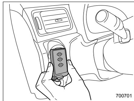
4. Удерживая ключ дистанционного доступа так, чтобы его кнопки были обращены к Вам, коснитесь им кнопки запуска/остановки двигателя. Когда процесс обмена данными между ключом дистанционного доступа и автомобилем будет завершен, раздастся звуковой сигнал (“динь”), а индикатор режима работы на кнопке запуска/остановки двигателя загорится зеленым светом.
