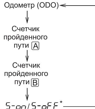
\* Когда замок зажигания находится в положении "ON", надписи "S-on" или "S-off" не отображаются.
