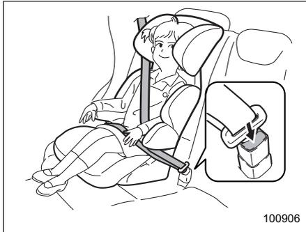
4. Для снятия дополнительной детской подушки нажмите на кнопку фиксатора на пряжке ремня безопасности и дайте ремню втянуться.
