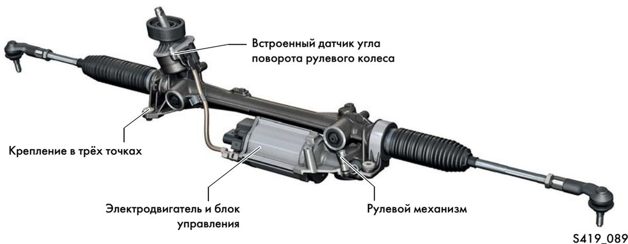
В Scigocso установлен электроусилитель рулевого управления 3-го поколения фирмы ZF.
