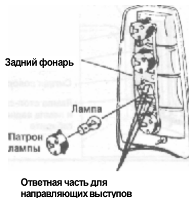
Рис. 6.40 Замена ламп заднего фонаря — показано для Универсала 240 Серии
