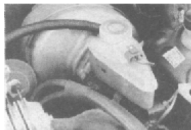
Рис. 1.33 Проверьте тормозную жидкость, не открывая крышку. Посмотрите, достигает ли уровень жидкости максимальной отметки на прозрачном бачке
