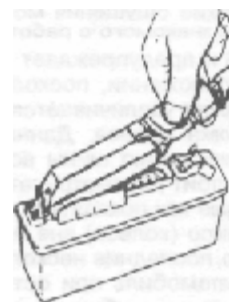
Рис. 9.31 Снимите проводку блока управления, нажав на стопорную пружину и достав разъем из его крепления
