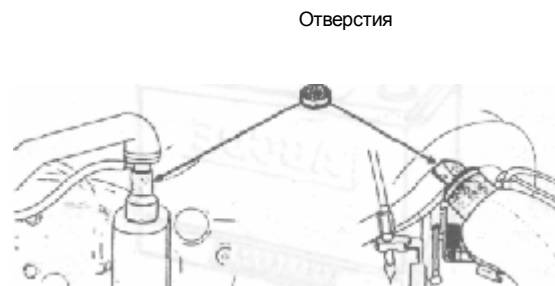
Рис. 1.12 Принудительная вентиляция картера двигателя В234F и В6304F
