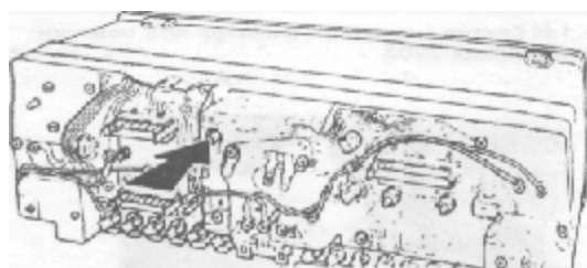
Рис. 1.24 Сброс указателя необходимости сервисного обслуживания — все модели 240/780 и 740 выпуска 1990 г.
