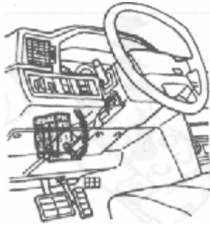
Блок управления (Motronic 1,8) Внутри панели со стороны водителя
